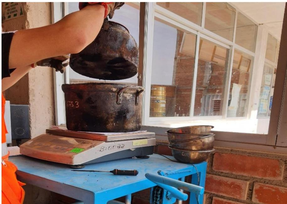
Foto N°28: Incorporación de bitumen asfáltico 60-70 a los agregados previamente pesados.
