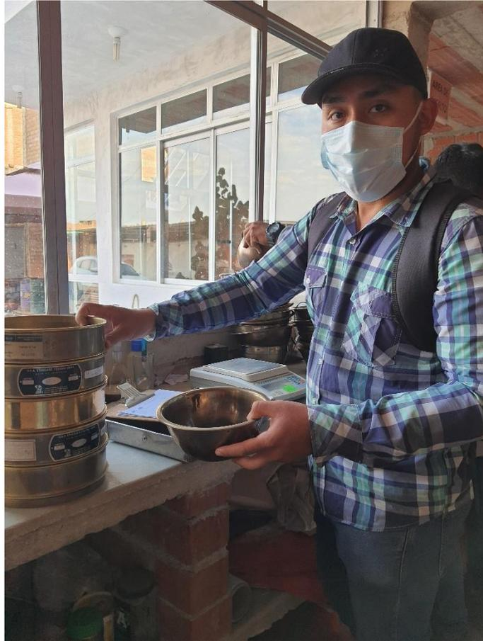
Foto N°23: Ensayo de granulometría de material fino.
