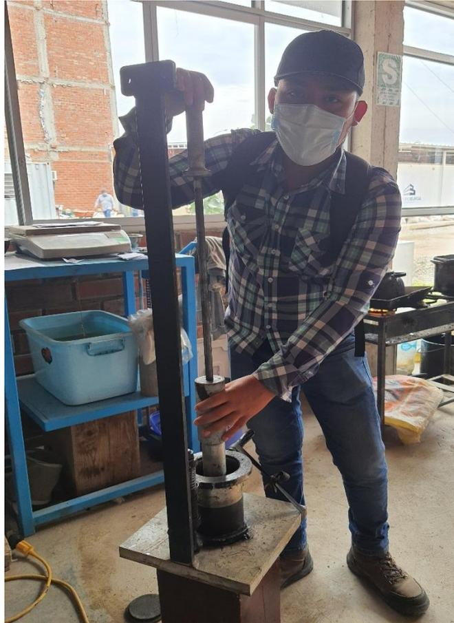
Foto N°32: Compactación de los materiales para la formación de briquetas, con 75 golpes por lado, dando un total de 150 golpes por briqueta.
