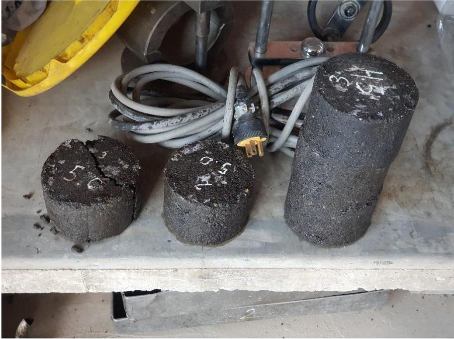
Foto N°38: Briquetas fracturadas en la prensa Marshal.
