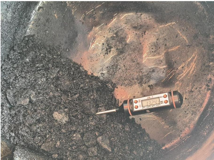
Foto N°30: Control de temperatura de los materiales mezclados para elaboración de briquetas.
