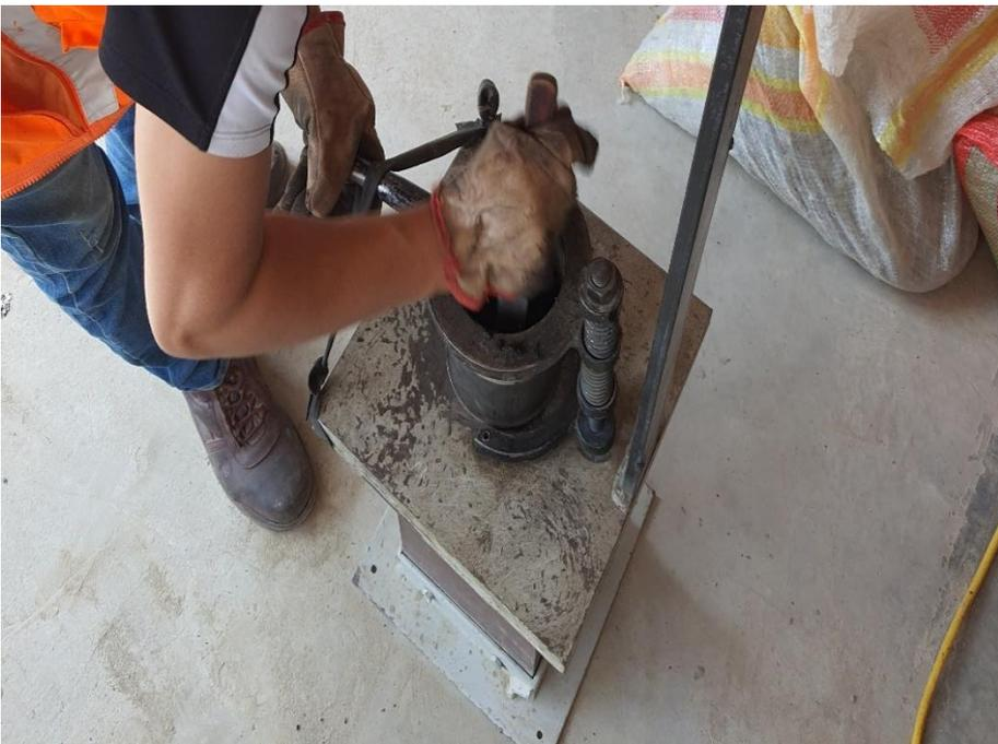
Foto N°31: Chuzado de los materiales vertidos en el molde para briquetas.
