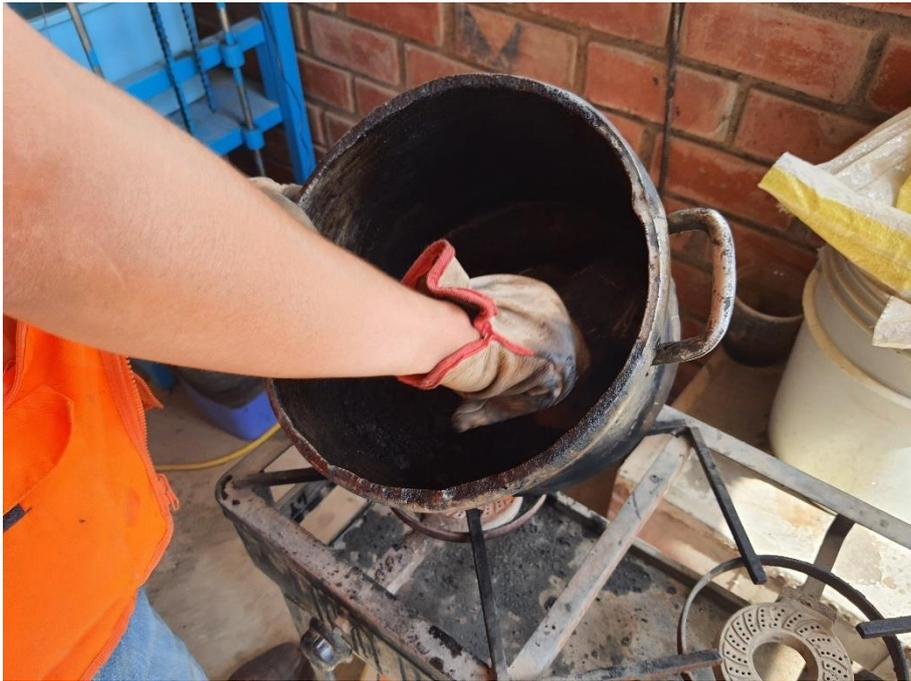
Foto N°29: Mezclado en caliente de materiales para la elaboración de briquetas.
