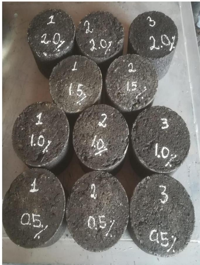
Foto N°35: discos de briquetas con incorporación de caucho reciclado en porcentajes de 0.5, 1.0, 1.5, 2.0 %.
