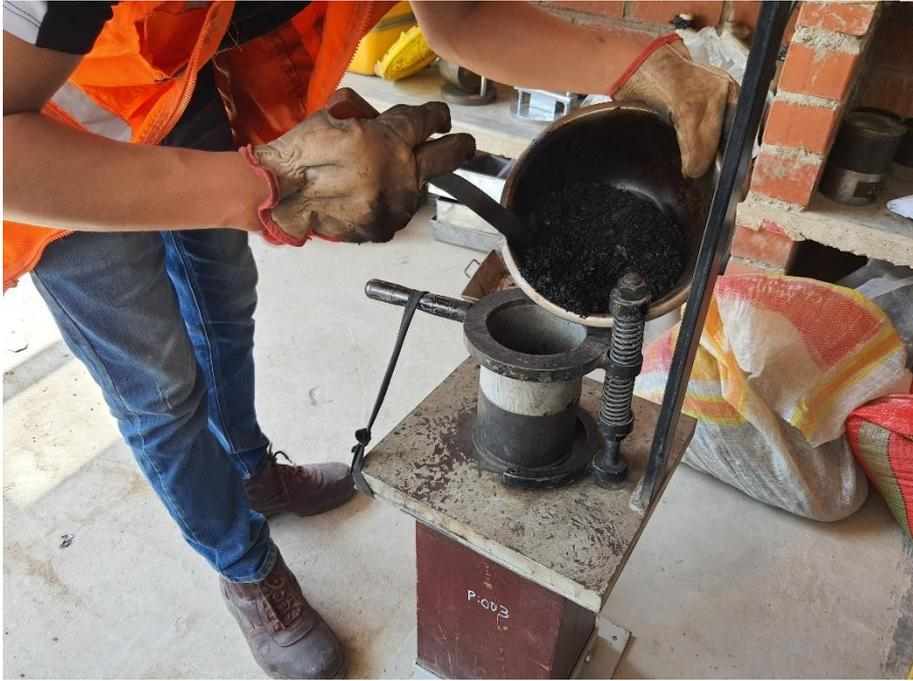
Foto N°30: Vaciado de los materiales en caliente al molde para briquetas.
