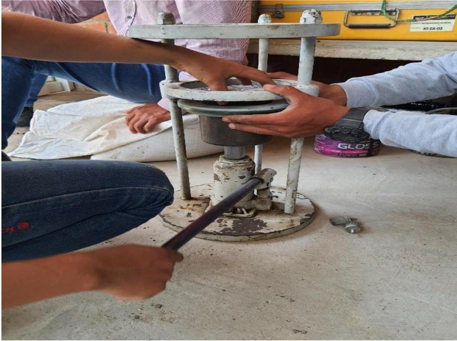
Foto N°34: Desmoldado de briquetas.
