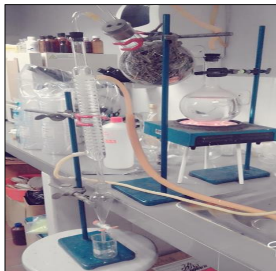
Figura 2: Procedimiento de la extracción de aceite esencial de Cymbopogon citratus .
