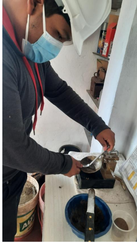
Fotografía N° 7 y 8. Ensayo EMS: Límites de Atterberg.
