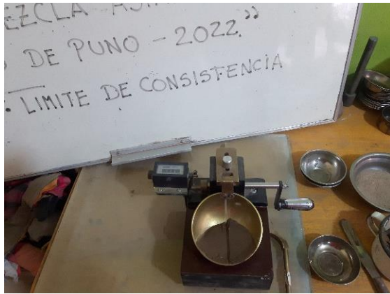
Figura 19: Aparato cuchara casa grande Fuente: Elaboración propia
