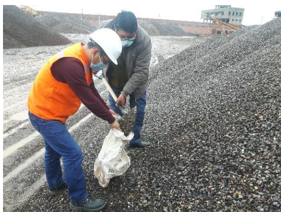
Figura 5: Extracción agregado grueso Fuente: Elaboración propia
