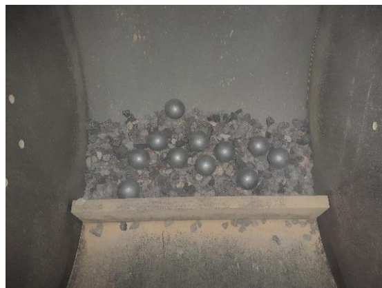
Figura 24: Bolas de acero de 420 gr. Fuente: Elaboración propia.
