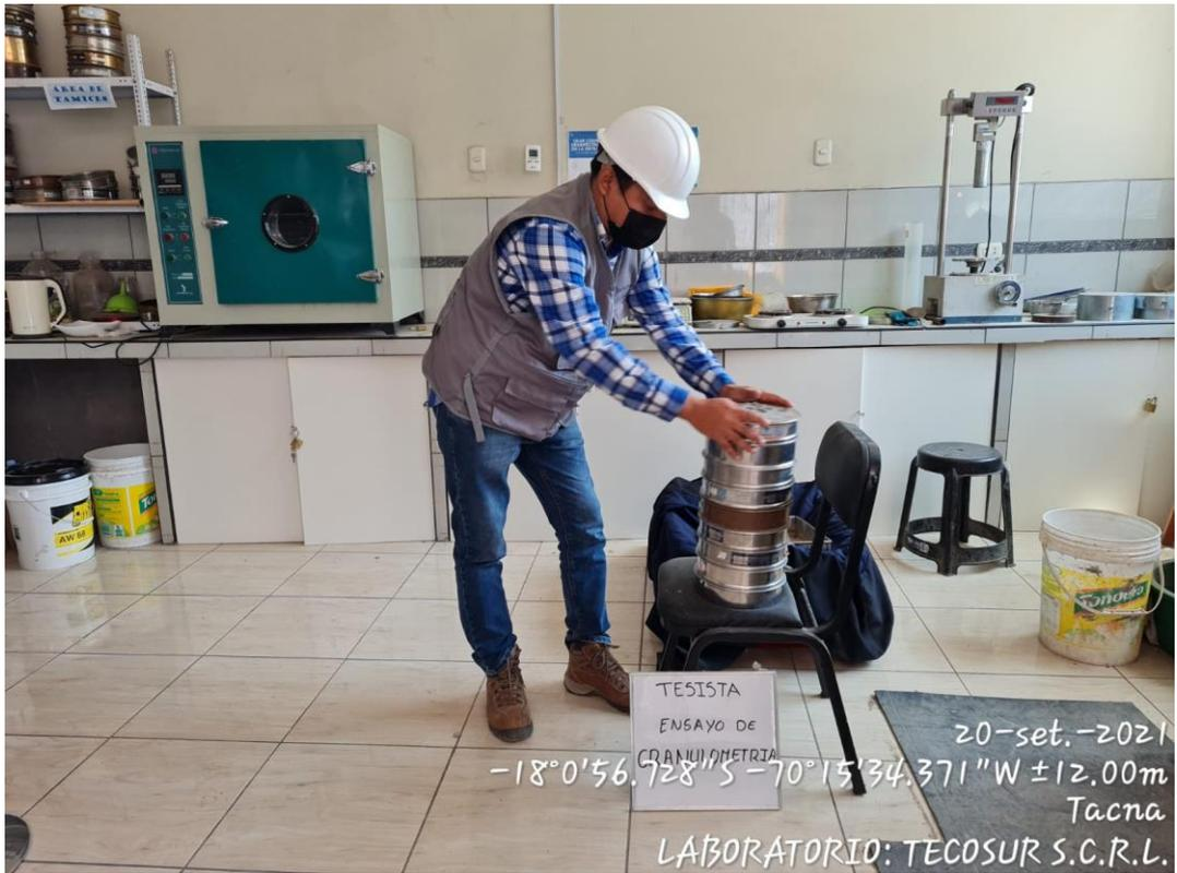
Anexo 36: ensayo de granulometría de los agregados según ASTM C-136.
