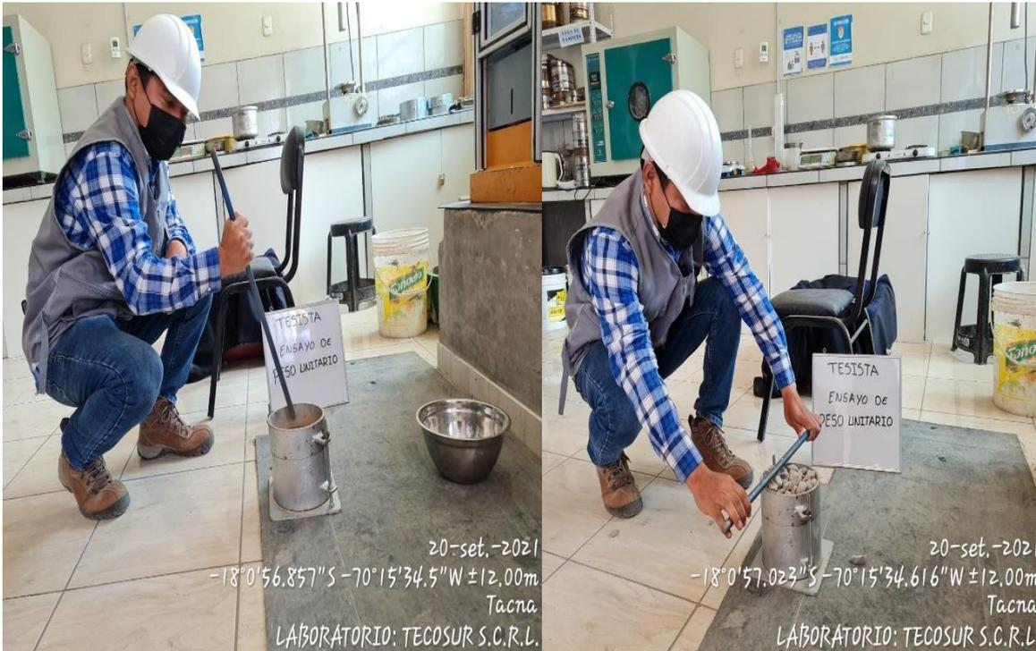
Anexo 38: ensayo del peso unitario según ASTM C-29
