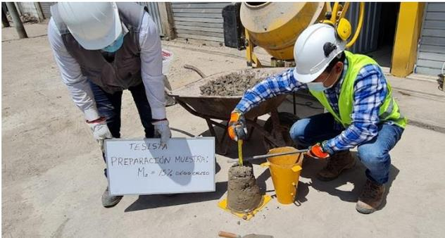
Anexo 42: Ensayo del asentamiento por Slump.
