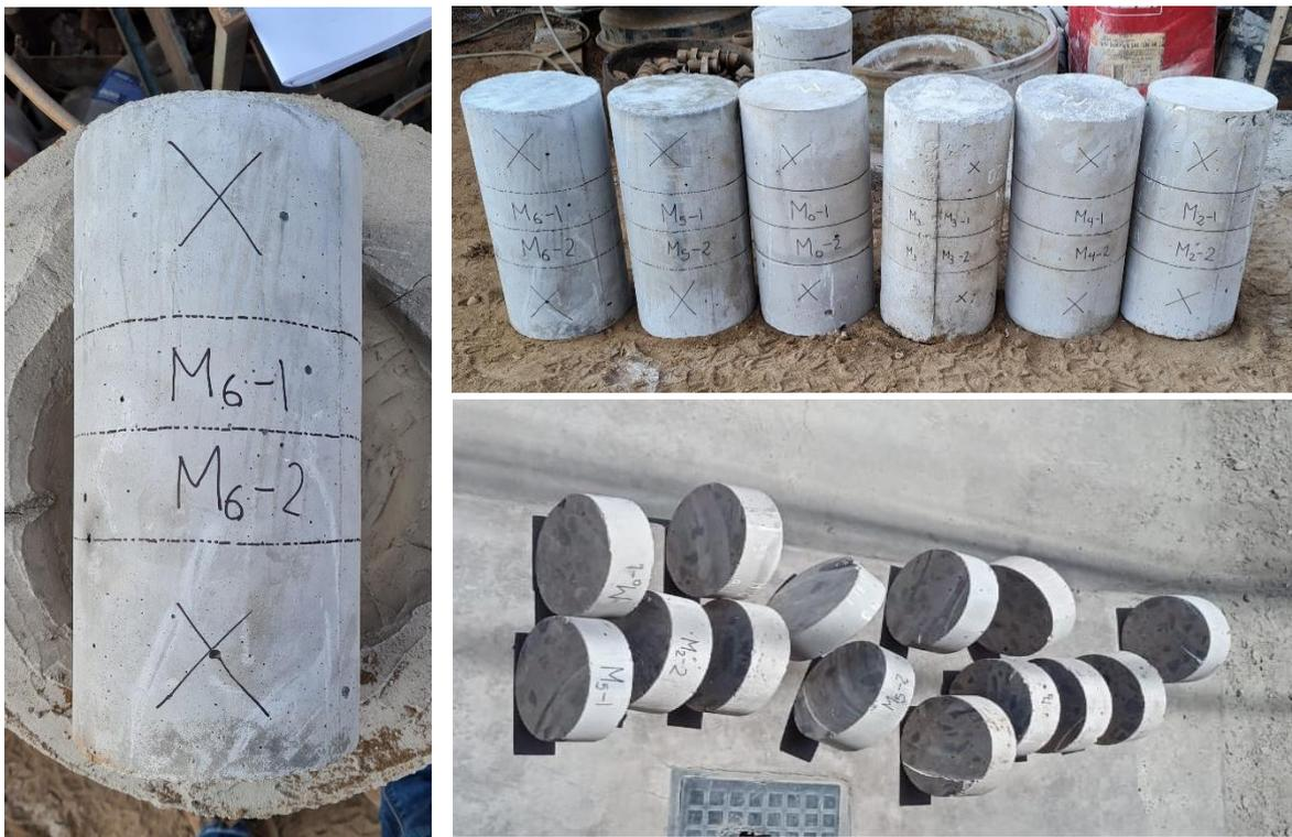
Anexo 49: Corte de probetas en muestras de 5 cm, para ensayo de porosidad.
