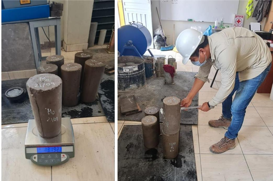
Anexo 46: pesado y medición (diámetro y altura) de testigos.
