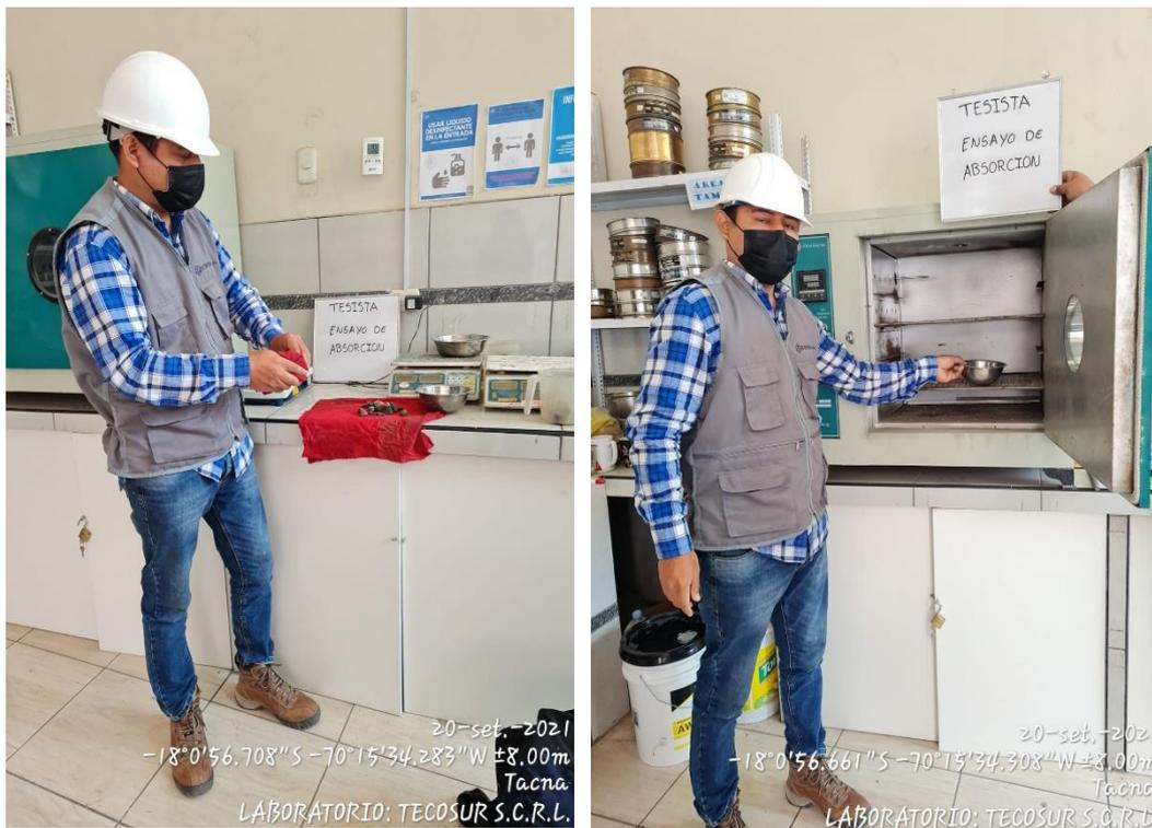
Anexo 39: ensayo del Absorción según ASTM C-128
