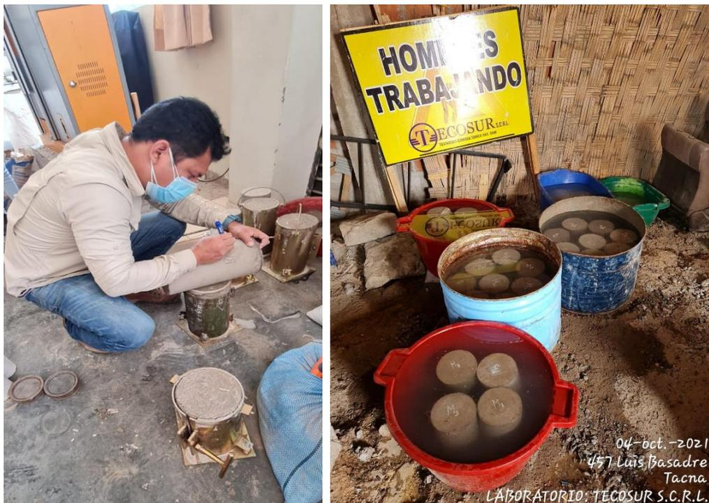
Anexo 45: Rotúralo y posterior curado de probetas.
