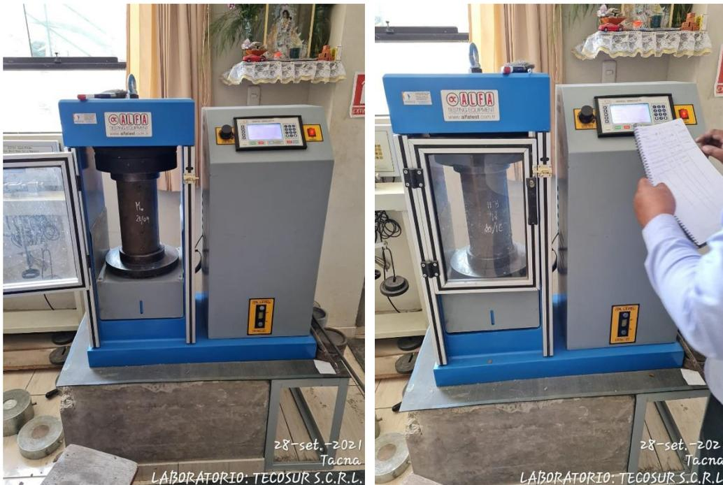
Anexo 47: Ensayo Resistencia a la compresión del concreto a los 7 días.
