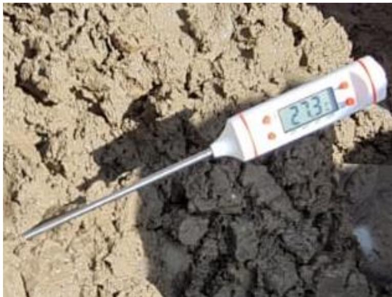
Anexo 43: Medición de la temperatura del concreto en estado fresco.
