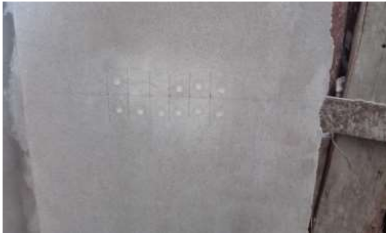
Figura 36. Puntos del ensayo de esclerometría
