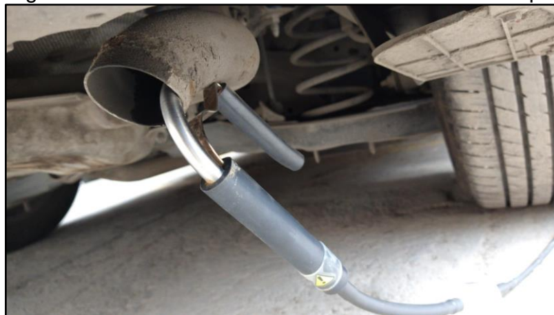
Figura 5. Procedimiento de medición en tubo de escape.
