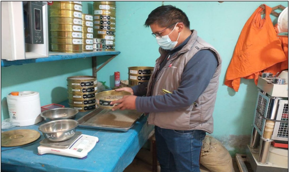
10.- Realizando el tamizado de muestras para la determinación de partículas en cada estrato.
