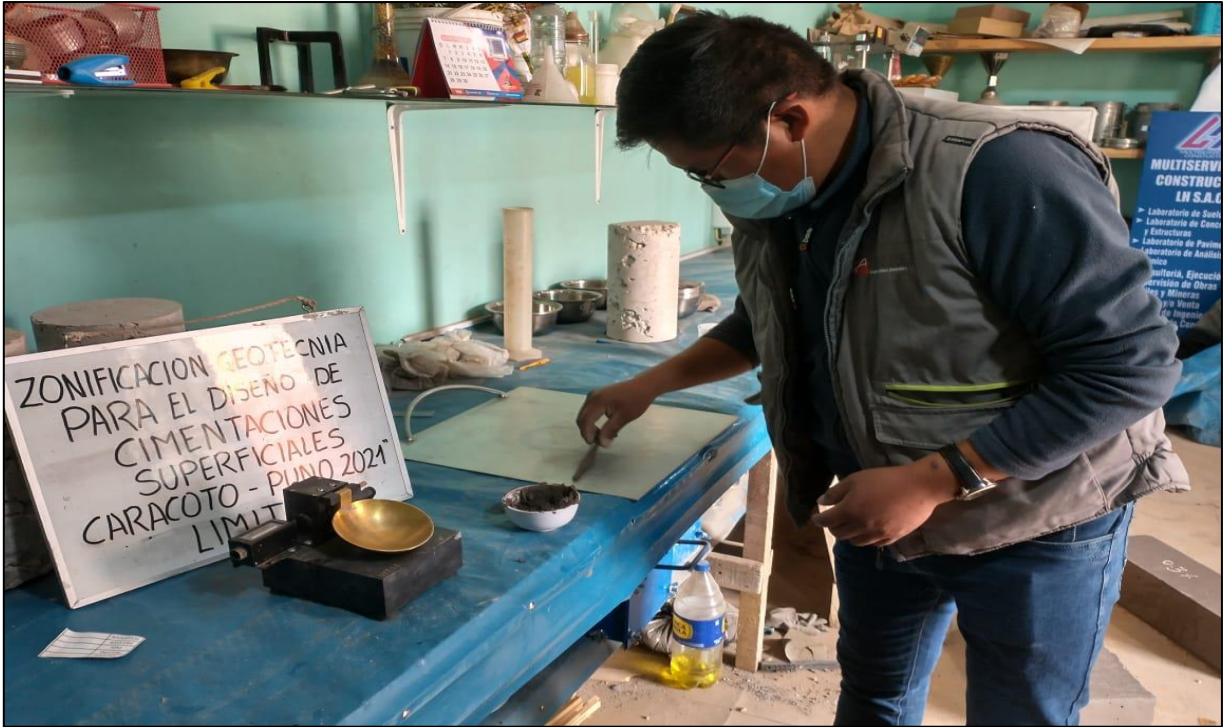
13.- Se realiza el ensayo de Límite de Plasticidad, haciendo cilindros de 3mm hasta que llegue a un punto de que se fisure.
