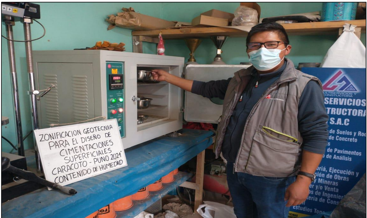
8.- Realizando el procedimiento Contenido de Humedad luego de pesarlo la muestra y llevado al horno.
