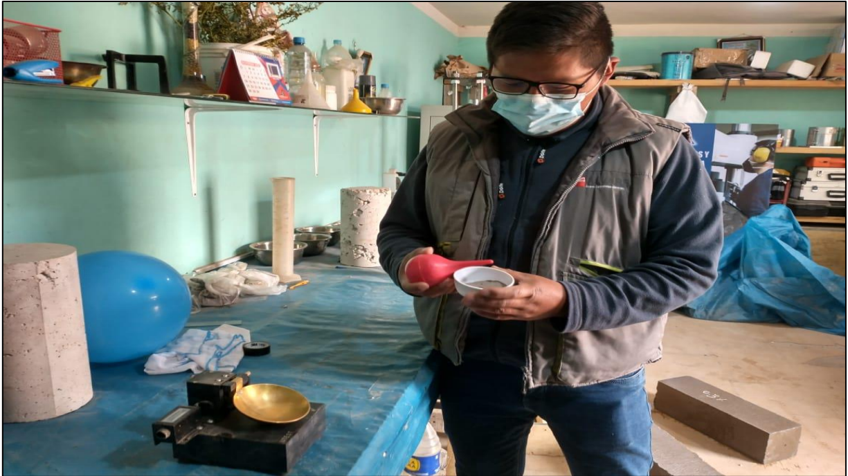
11.- Se realiza el ensayo del Límite Líquido, con el equipo de casa grande a diferentes golpes.
