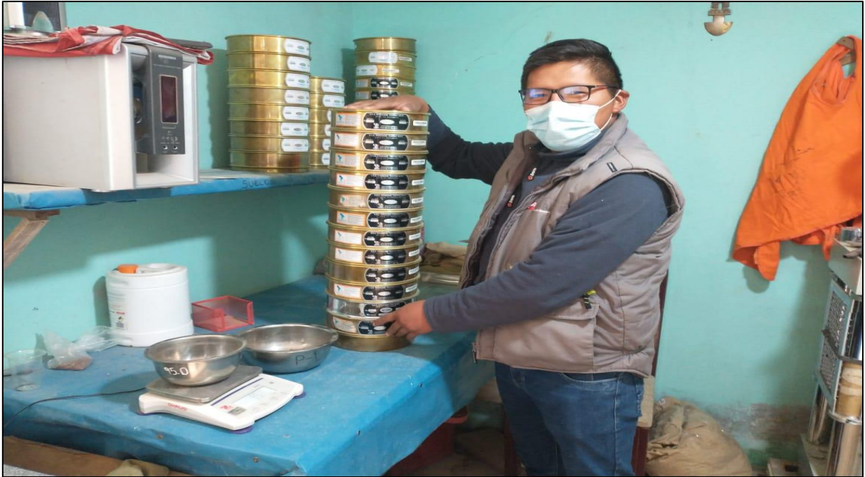
9.- Realizando el ensayo de Análisis Granulométrico por Tamizado, para determinar el porcentaje de partículas.
