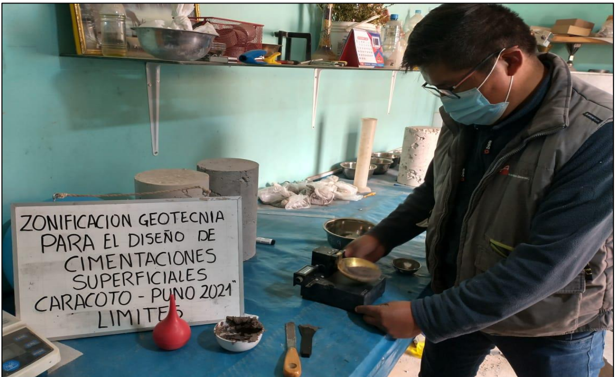
12.- Se realiza el procedimiento con el equipo de casa grande en cada muestra.
