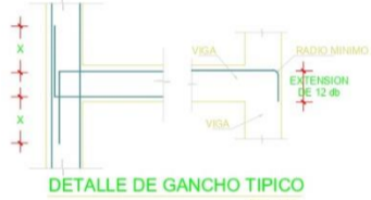
DETALLE DE GANCHO TIPICO RADIO MINIMO DE DOBLEZ Esc: 1/50
