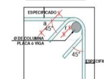
DETALLE DE DOBLADO DE ESTRIBOS
