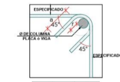
DETALLE DE DOBLADO DE ESTRIBOS
