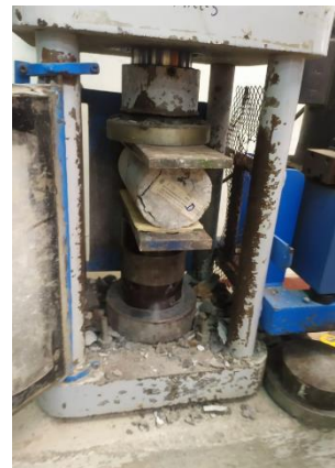
Falla de probeta a la compresión diametral
