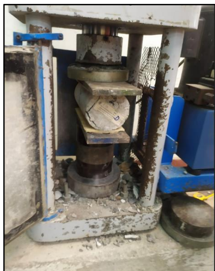
Figura N° 6 – Falla de probeta a la tracción.
