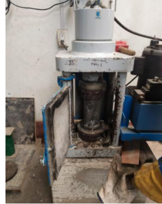
Falla de Probeta a la compresión
