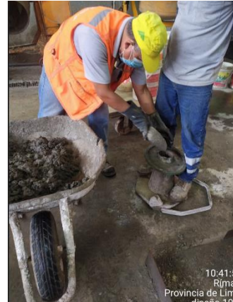
Ensayo de Slump
