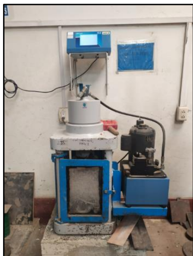
Figura N° 3 – Equipo para ensayos a la compresión.
