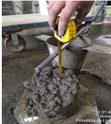
Ensayo de Slump
