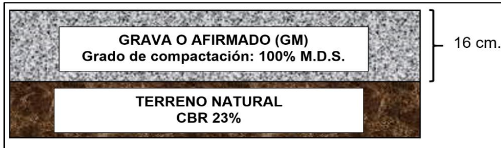
Figura 16: Resultado final del diseño de pavimento de afirmado por el Método TRRL.
