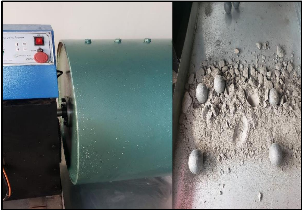
Figura 30: Foto de ensayo de desgaste de Los Ángeles.
