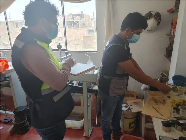
Imagen 05: Ensayo límite de plasticidad
