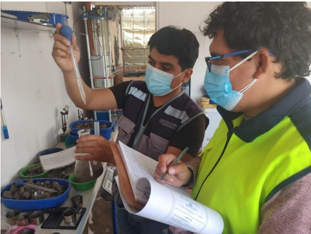
Imagen 07: Ensayo contenido de sales
