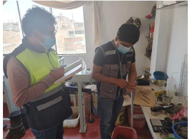
Imagen 06: Ensayo límite de plasticidad
