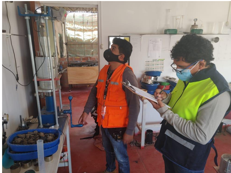
Imagen 10: Ensayo de CBR
