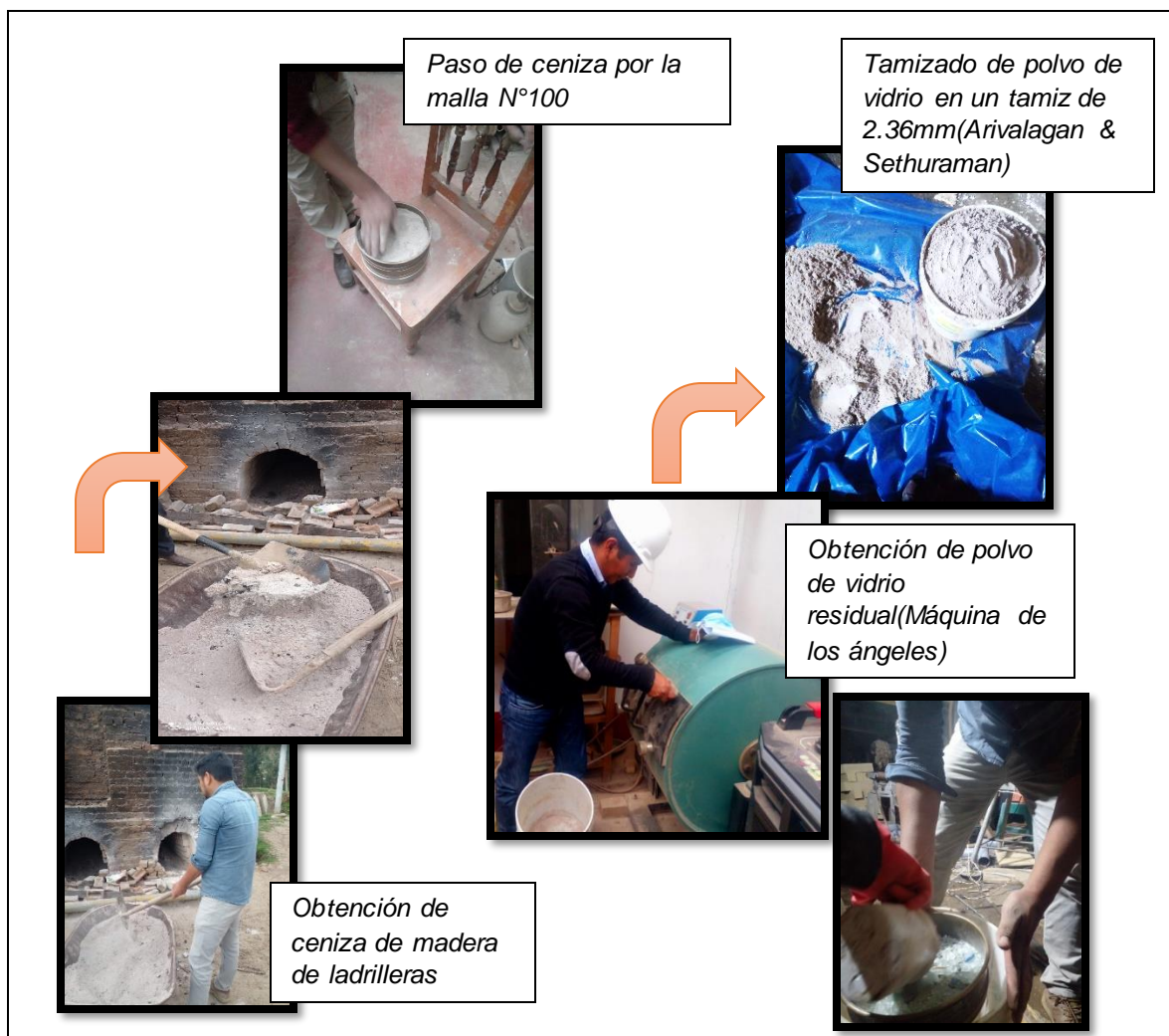
Figura 3: Proceso de adquisición de ceniza de madera y polvo de vidrio residual
