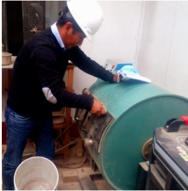
Ilustración 2.- Obtención del polvo de vidrio y tamizado.
