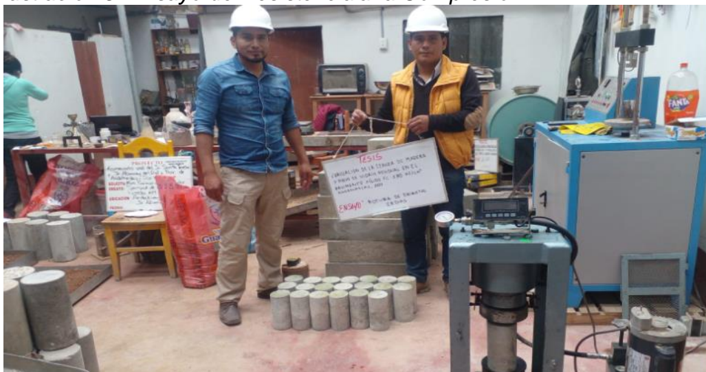
Ilustración 5.-Ensayo de Resistencia a la Compresión
