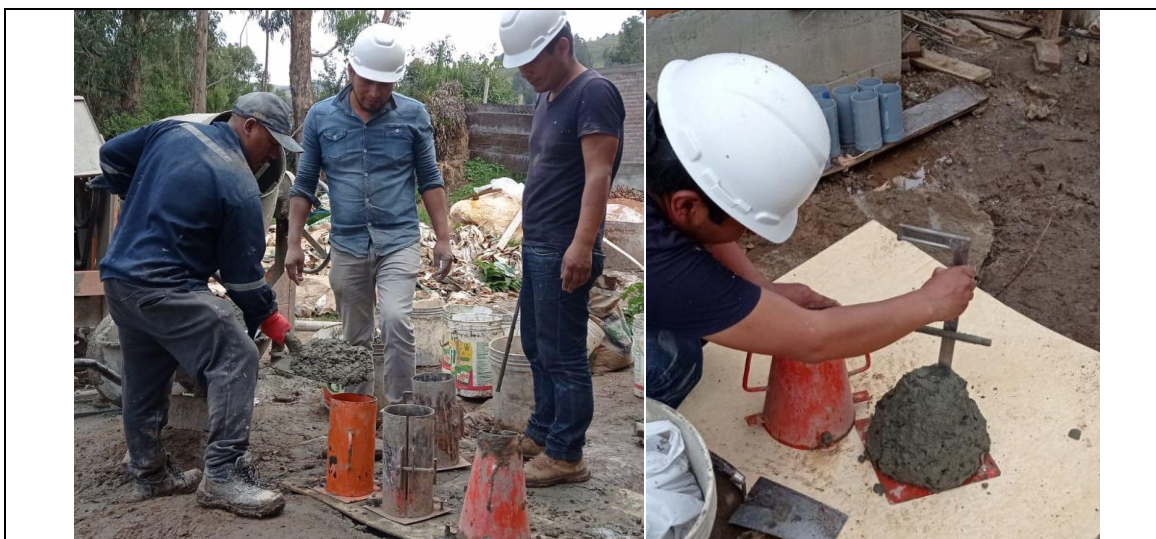
Figura 20. Ensayo de consistencia del concreto en el laboratorio
