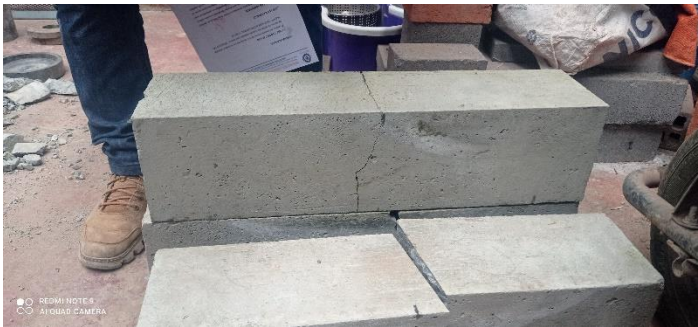
Ilustración 6.- Ensayo de Resistencia a flexión
