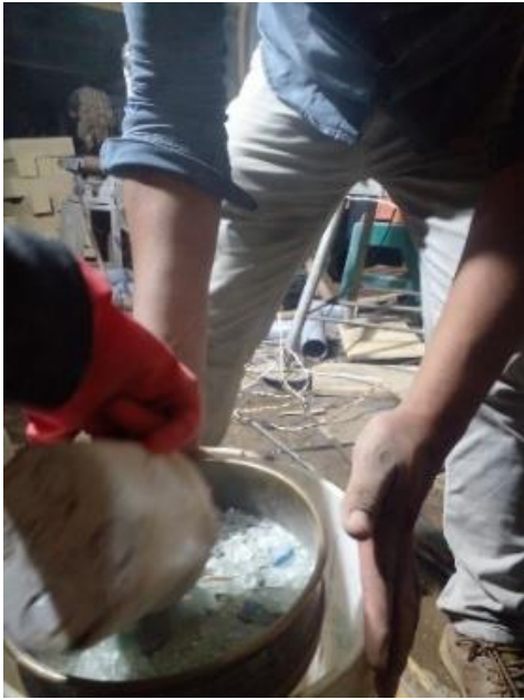
Ilustración 2.- Obtención del polvo de vidrio y tamizado.
