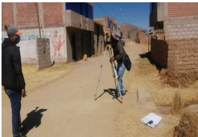
Figura 13. Levantamiento Topográfico Red Distribución
