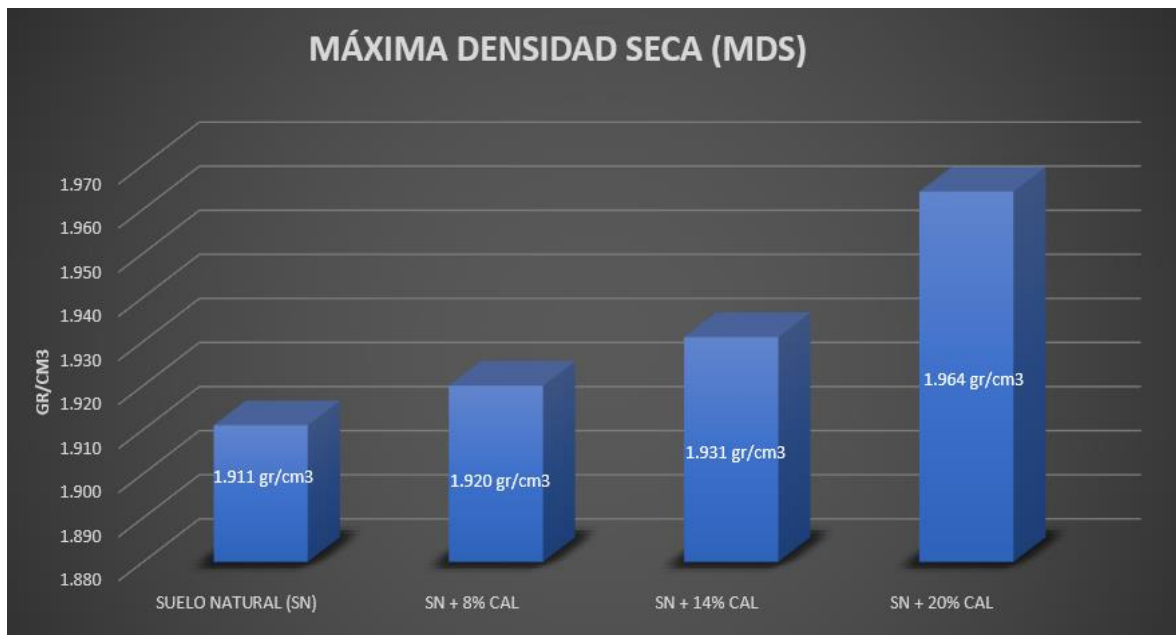
Gráfico 12: Máxima Densidad Seca (MDS) con la incorporación de la CAL.
