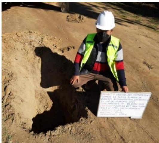
Se aprecia la extracción de la muestra para el EMS de la vivienda 01.
