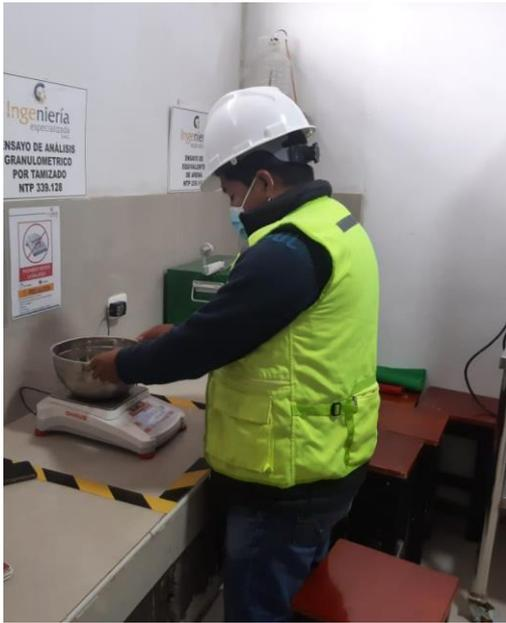
Se aprecia el pesado de la muestra para realizar los diferentes ensayos de Mecánica de suelos.
