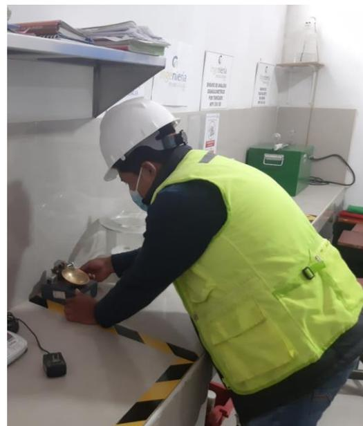
Se aprecia el ensayo con la copa de Casagrande para la obtener el límite líquido.
