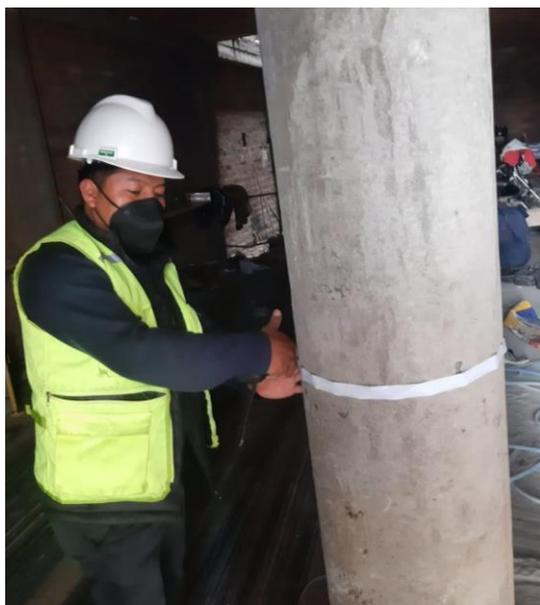
Se aprecia la medición de una columna circular para rellenar la ficha de recolección de datos de la vivienda 02.
