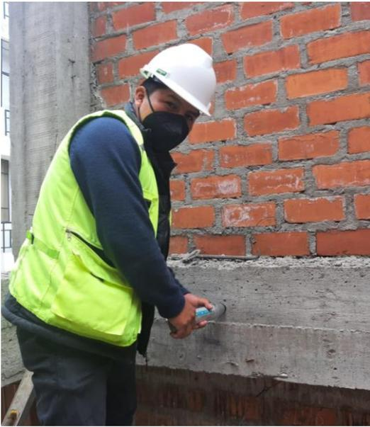
Se realiza el ensayo de esclerometría en viga principal de la vivienda 02.
