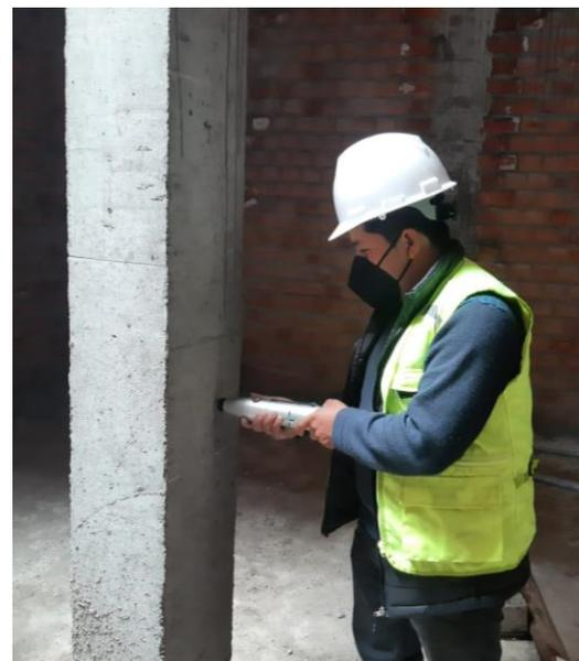
Se realiza el ensayo de esclerometría en columna céntrica de la vivienda 01.
