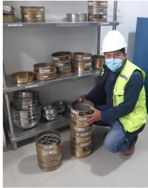
Se aprecia la selección de tamices para el ensayo de granulometría.
