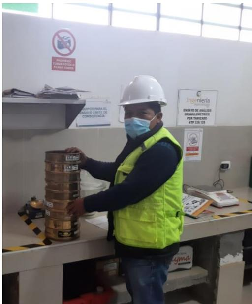
Se aprecia el tamizado para el ensayo de granulometría.
