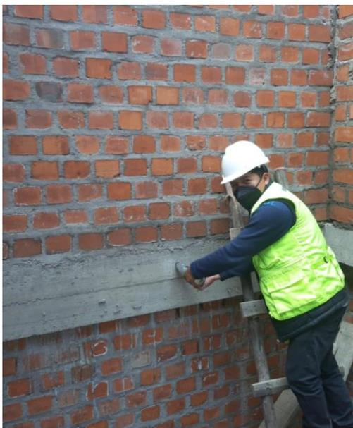
Se realiza el ensayo de esclerometría en viga principal de la vivienda 01.
