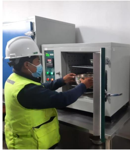
Pasado el tiempo prudencial se aprecia el retiro de la muestra del horno para obtener el contenido de humedad.
