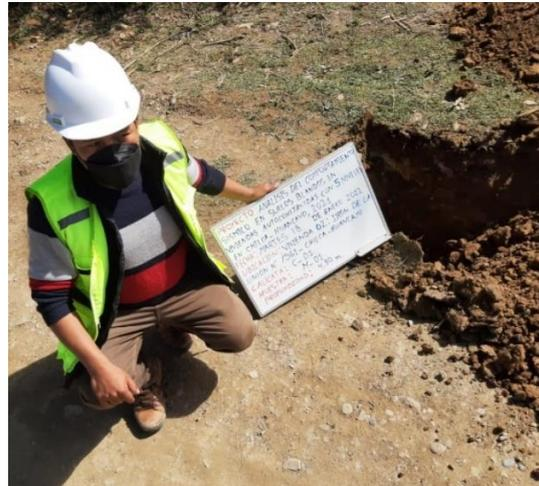
Se aprecia la extracción de la muestra para el EMS de la vivienda 02.
