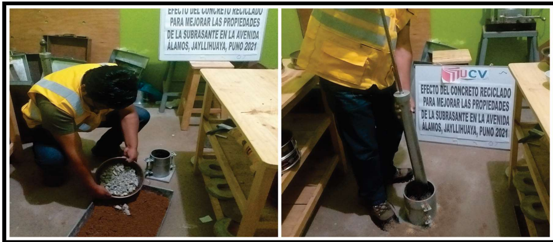
Figura 23. Ensayo de proctor de energía modificada con adición de 5%, 15% y 25% de concreto reciclado.
