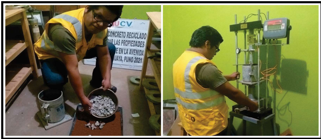
Figura 26. Ensayo de C.B.R con adición de 5%, 15% y 25% de concreto reciclado
