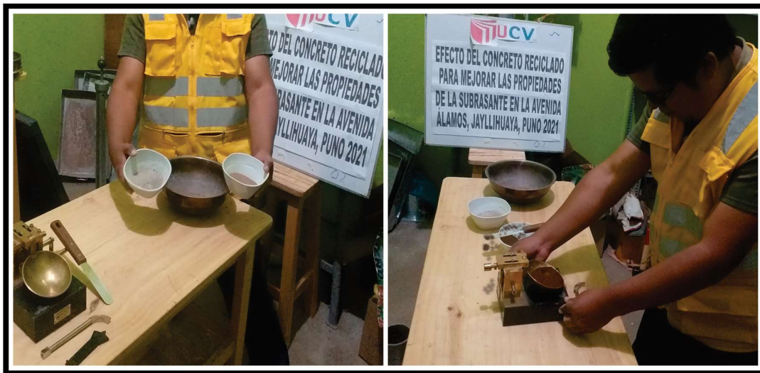
Figura 21. Ensayo de límites de consistencia con adición de 5%, 15% y 25% de concreto reciclado
