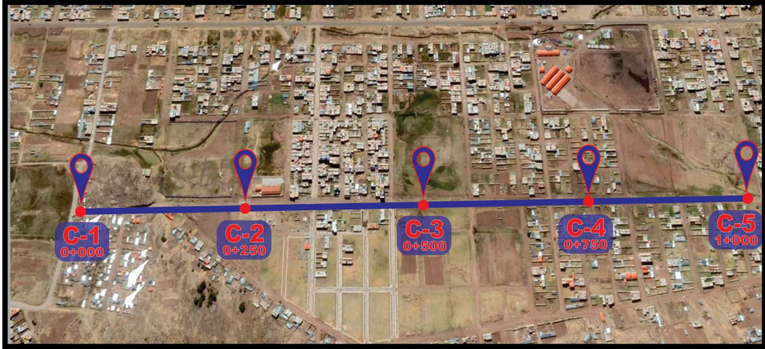
Figura 12. Ubicación de calicatas a lo largo de la Avenida Álamos
