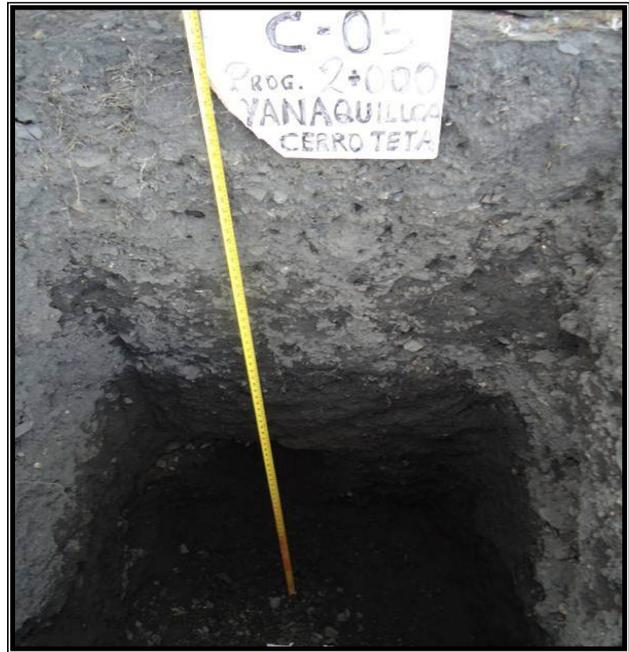
**Fotografía 02:** obtención de muestra de las calicatas
