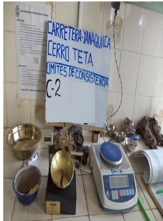
**Fotografía 08:** ensayo de limite de consistencia
