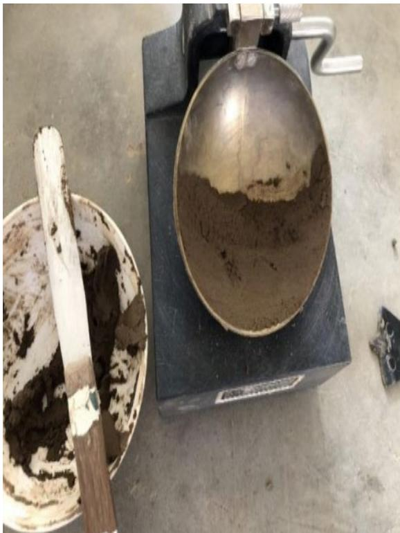
**Fotografía 07:** ensayo limite de consistencia
