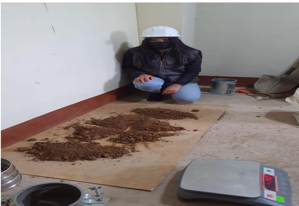
**Fotografía 03:** ensayo de granulometría de las muestras
