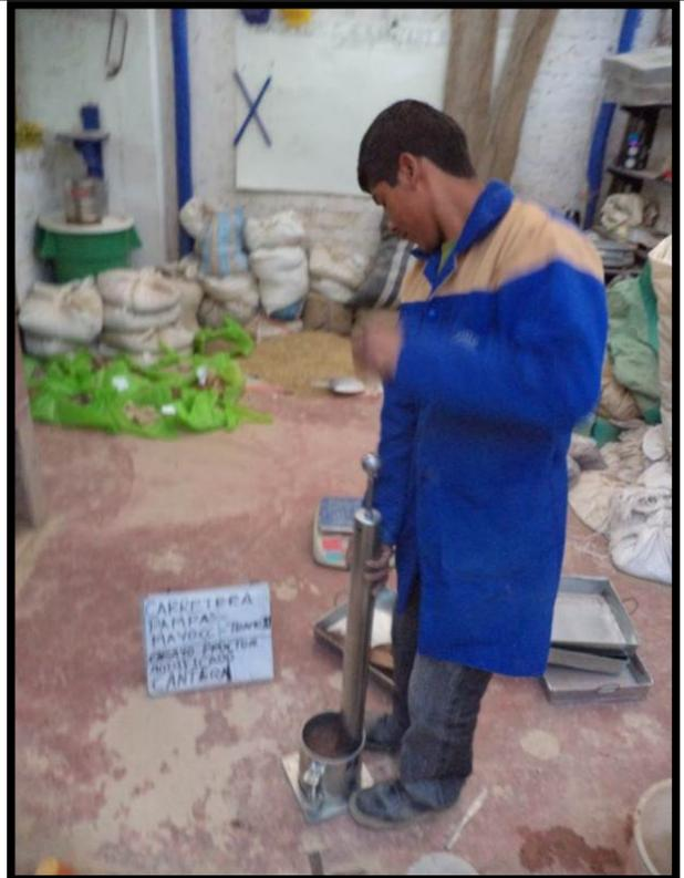
**Fotografía 10:** ensayo de Proctor modificado
