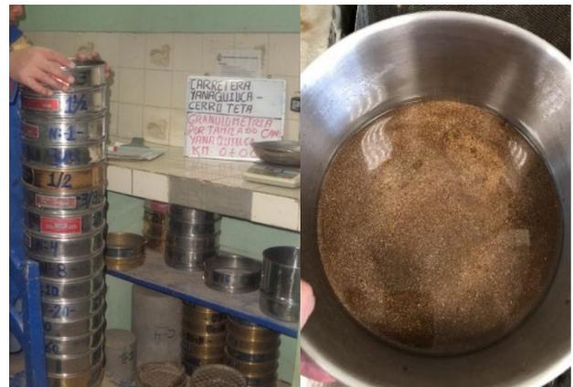
**Fotografía 04:** ensayo de granulometría de las muestras
