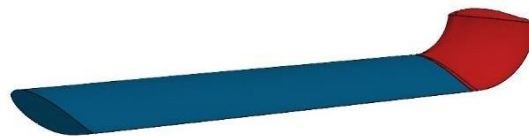
Figura 32: aleta del álabe de una turbina de viento.
