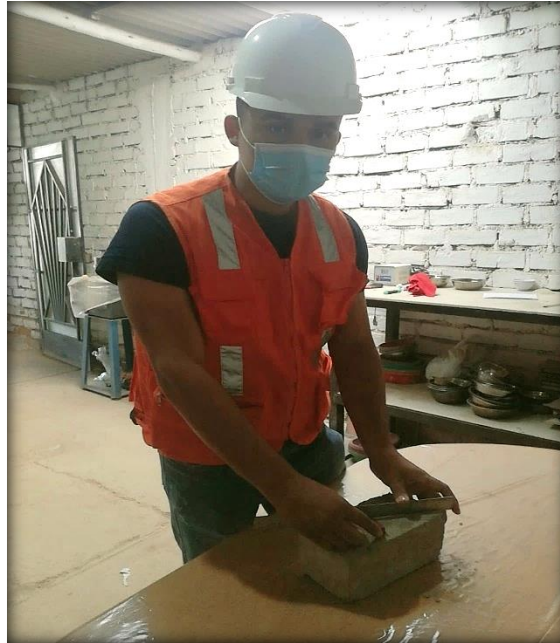
Figura N° 14: Verificando el alabeo de la unidad de albañilería.
