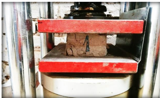
Figura N° 19: Especimen N° 1 recibiendo presión por parte de la prensa.
