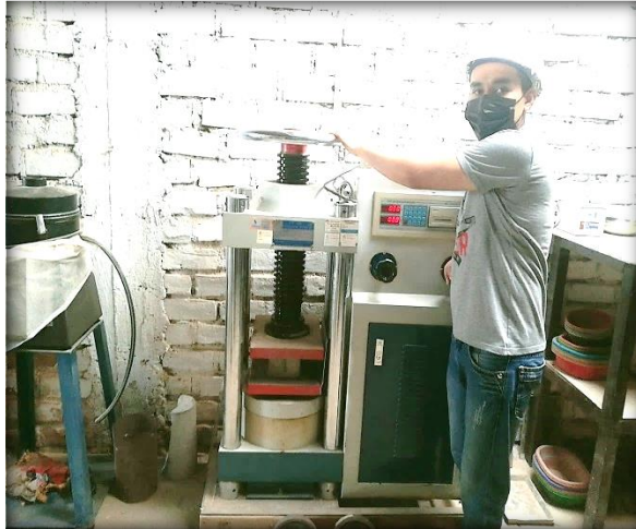
Figura N° 17: Empezando con la rotura de la unidad de albañilería.
