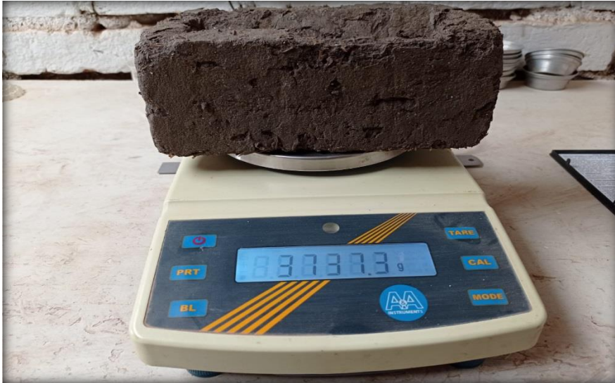
Figura N° 16: Verificando la absorción de la unidad de albañilería.
