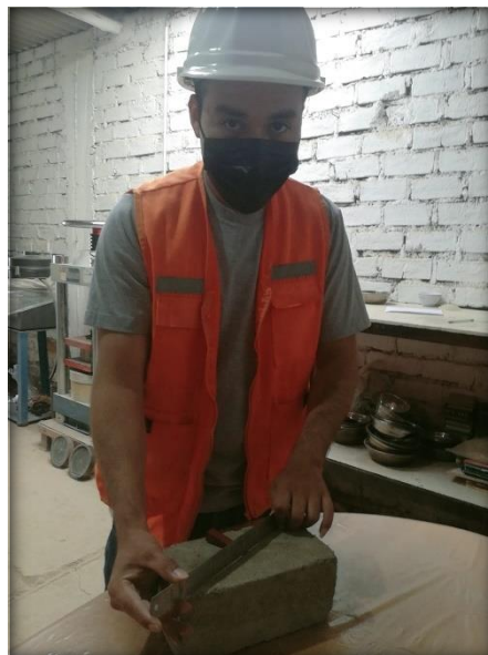
Figura N° 15: Verificando el alabeo de la unidad de albañilería.
