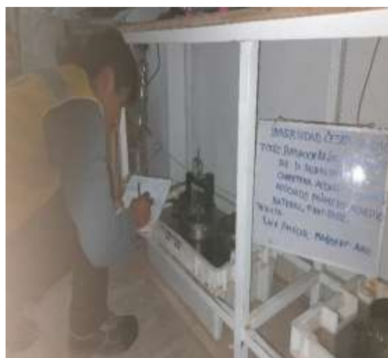
Figura N° 25: Lectura de expansión. Fuente: Elaboración Propia
