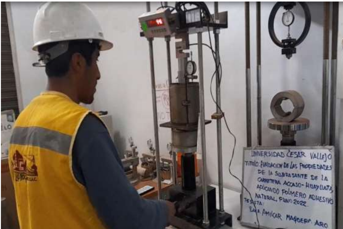
Ensayo de CBR (penetración).
