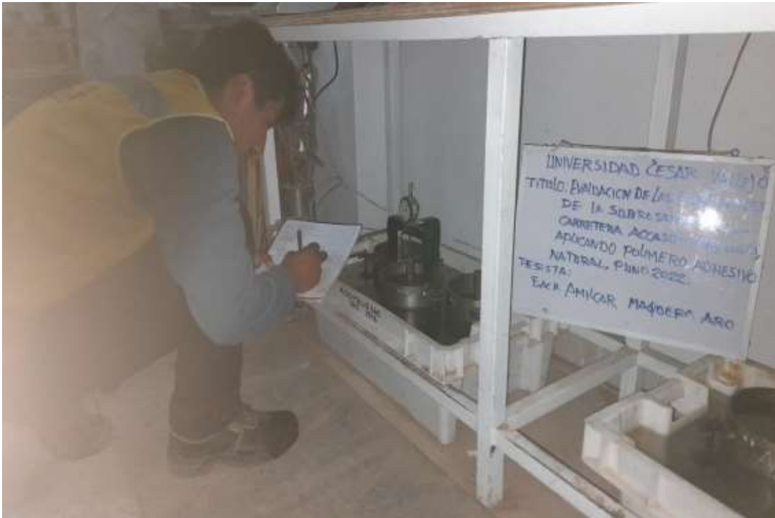
Toma de medidas de la expansión de los especímenes de la calicata C – 03.
