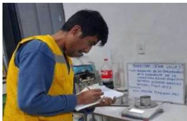
Figura N° 19: Pesado del espécimen seco del SN.
