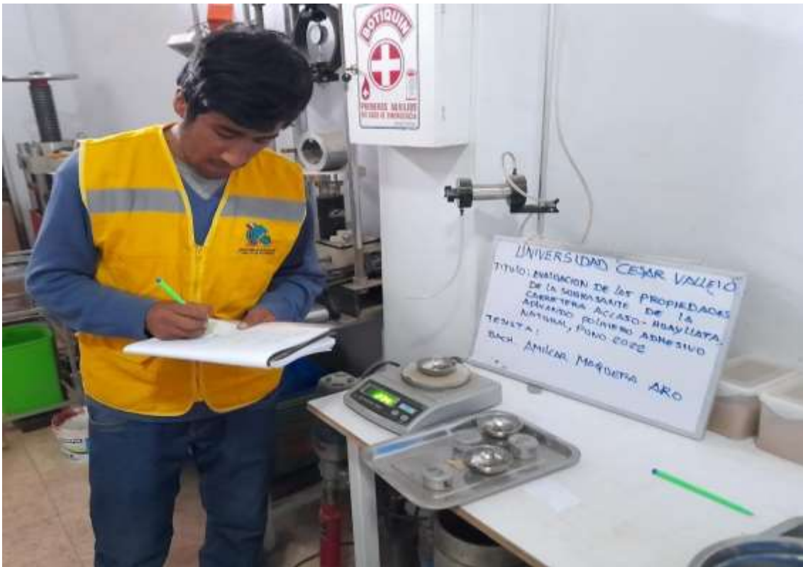
Lectura del peso de las muestras en el ensayo de Limites de Atterberg.
