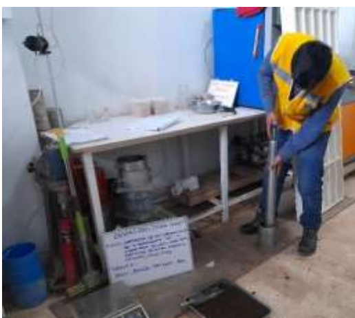
Figura N° 21: Ensayo de Proctor.
