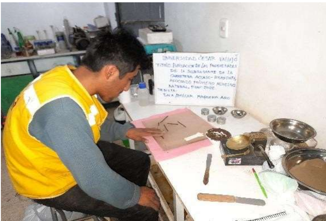
Ensayo de límite plástico: Material pasante del tamiz N°40.
