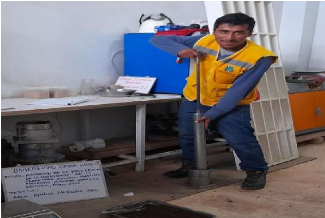
Compactado de las diferentes capas en el ensayo de Proctor Modificado
