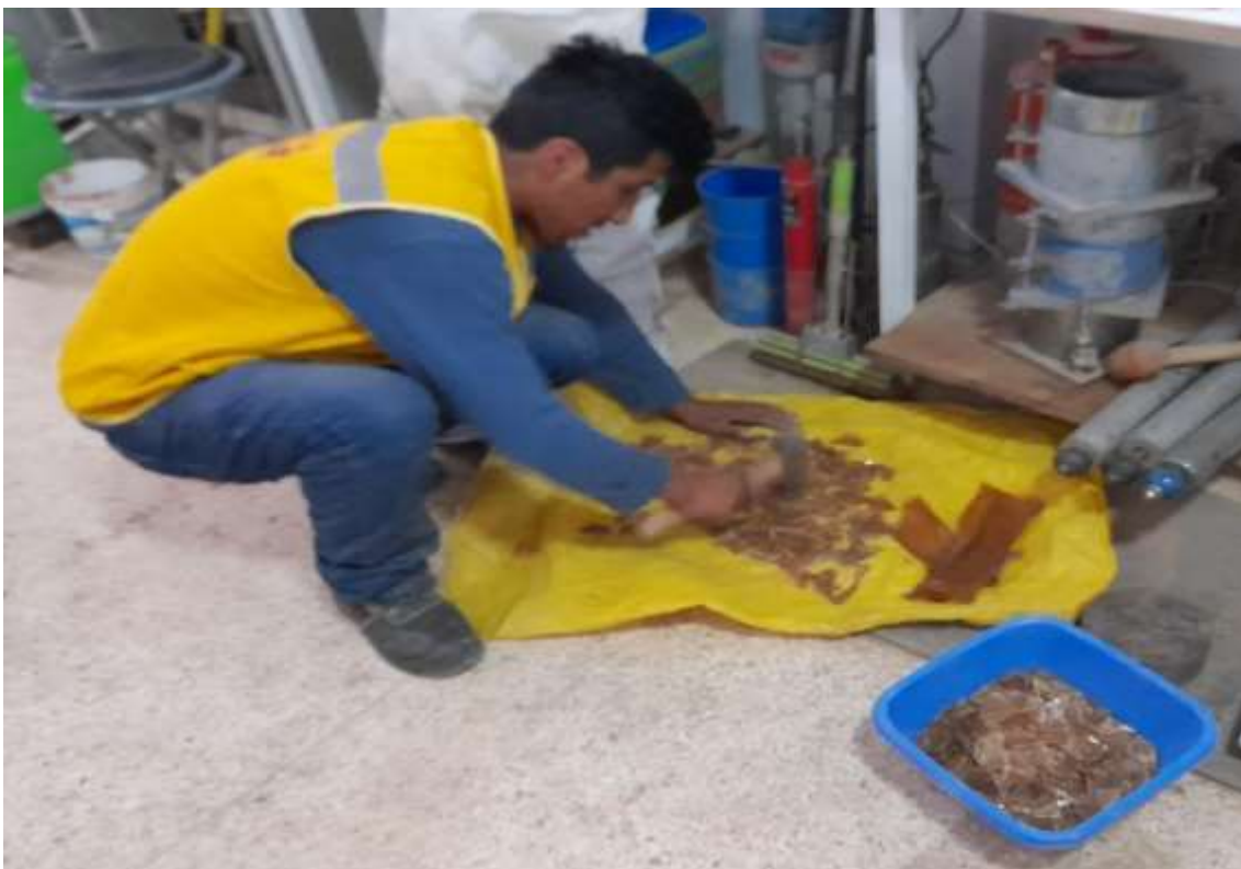
Preparación del Polímero Adhesivo Natural para su incorporación en el suelo natural.
