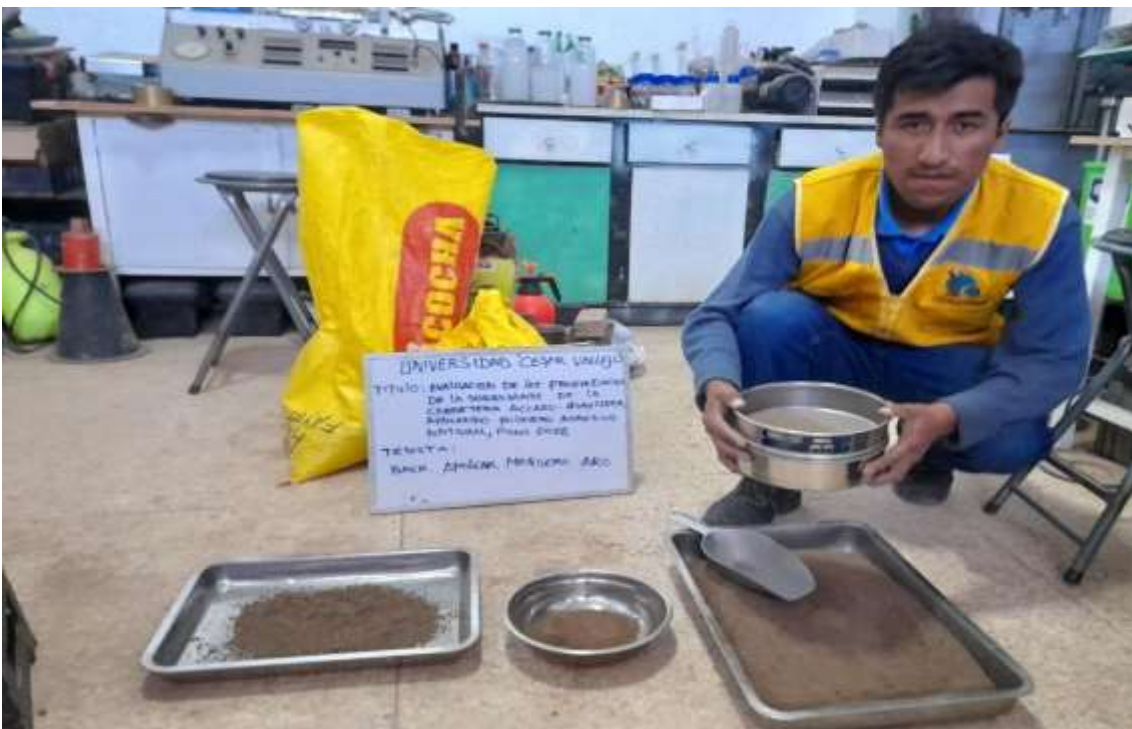
Ensayo de granulometría: Material pasante del tamiz N°40.
