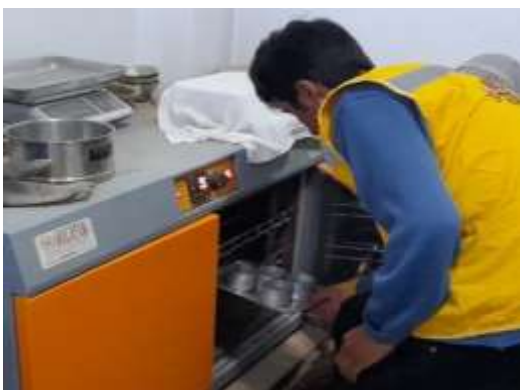
Figura N° 18: Metido al horno del espécimen natural.
