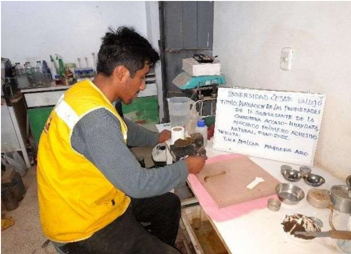
Ensayo de límite líquido: Material pasante del tamiz N°40.
