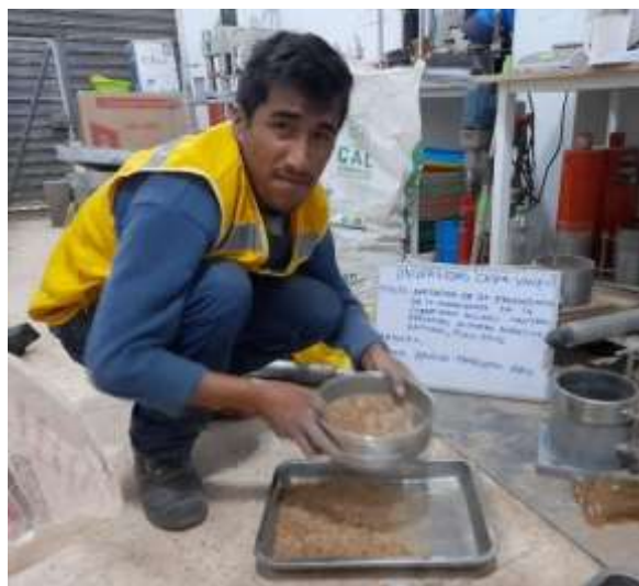
Figura N° 10: Cernido de PAN. Fuente: Elaboración Propia
