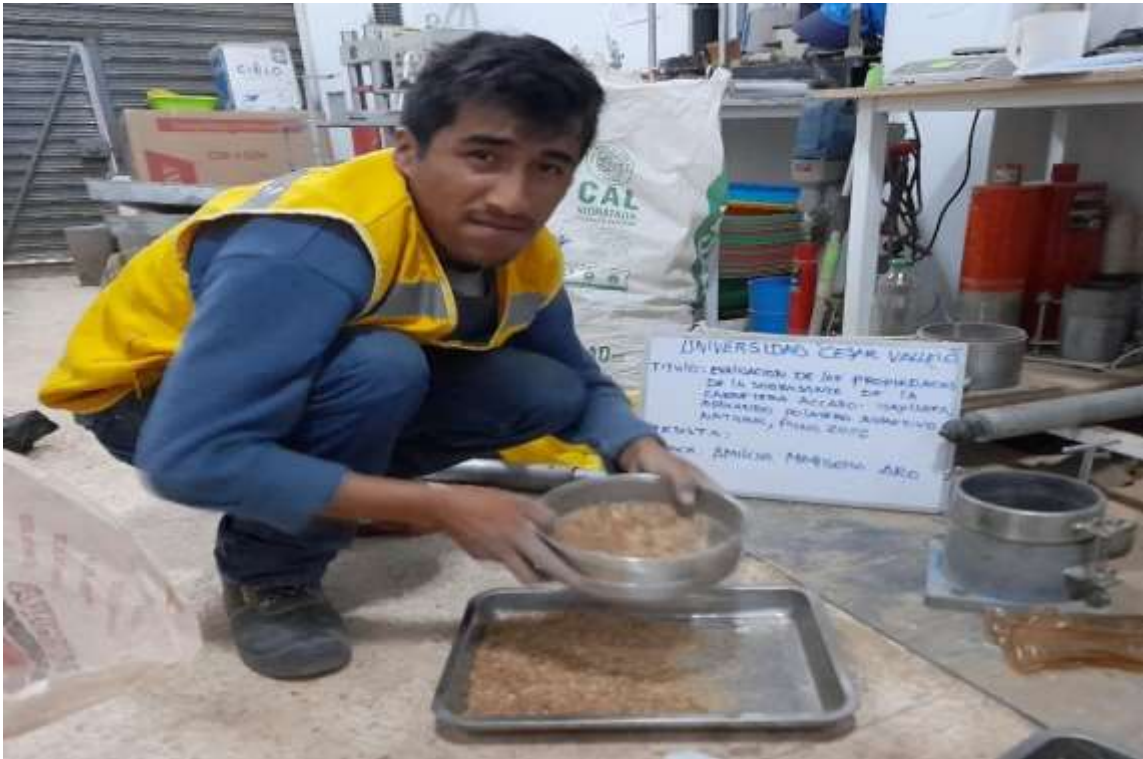
Tamizado del Polímero Adhesivo Natural con la malla N°4
