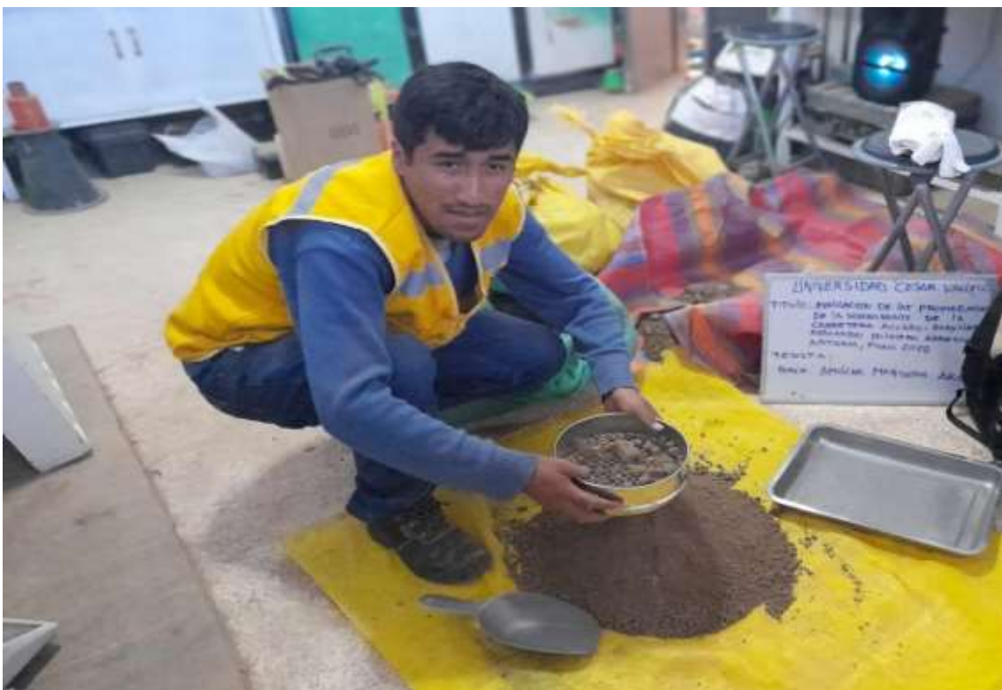
Tamizado de la muestra para la realización del ensayo de Proctor Modificado.
