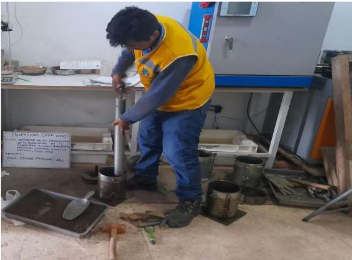
Compactado de las capas en el ensayo de CBR.
