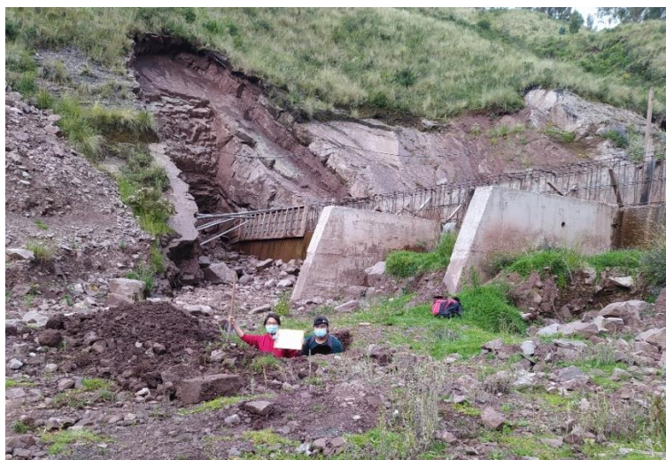
Figura 29. Extracción de muestra del terreno en el relleno de tierra en calicata.
