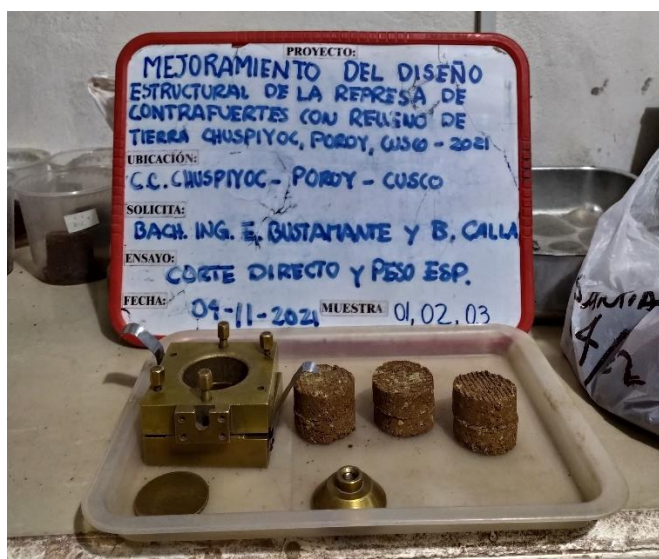
Figura 34. Tres muestras de Laboratorio para el ensayo de corte Directo
