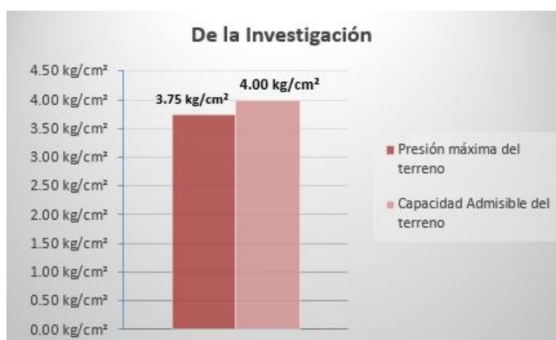
Figura 153. Representación Gráfica de Verificación Capacidad Admisibile del terreno de la investigación.
