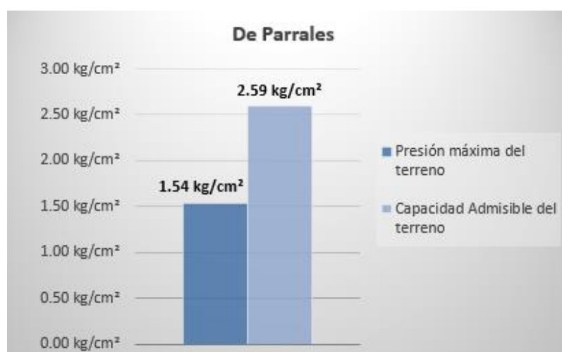
Figura 154. Representación Gráfica de Verificación Capacidad Admisibile del terreno de Parrales (2020).
