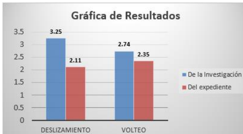
Figura 145 Comparación de los factores de Seguridad con relleno y sin relleno de tierra.
