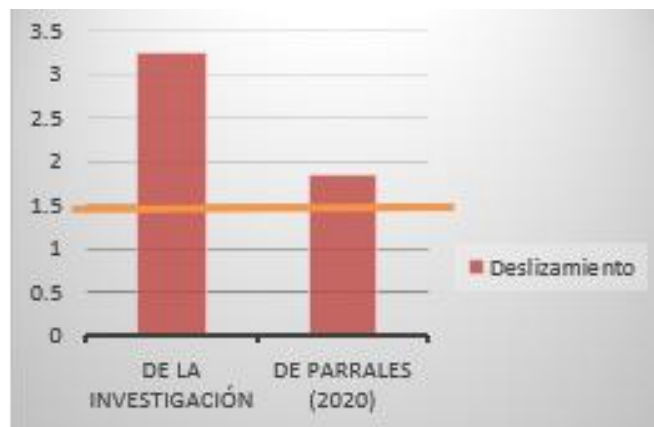
Figura 151. Representación Gráfica del F.S. al deslizamiento entre la investigación y Parrayes (2020).
