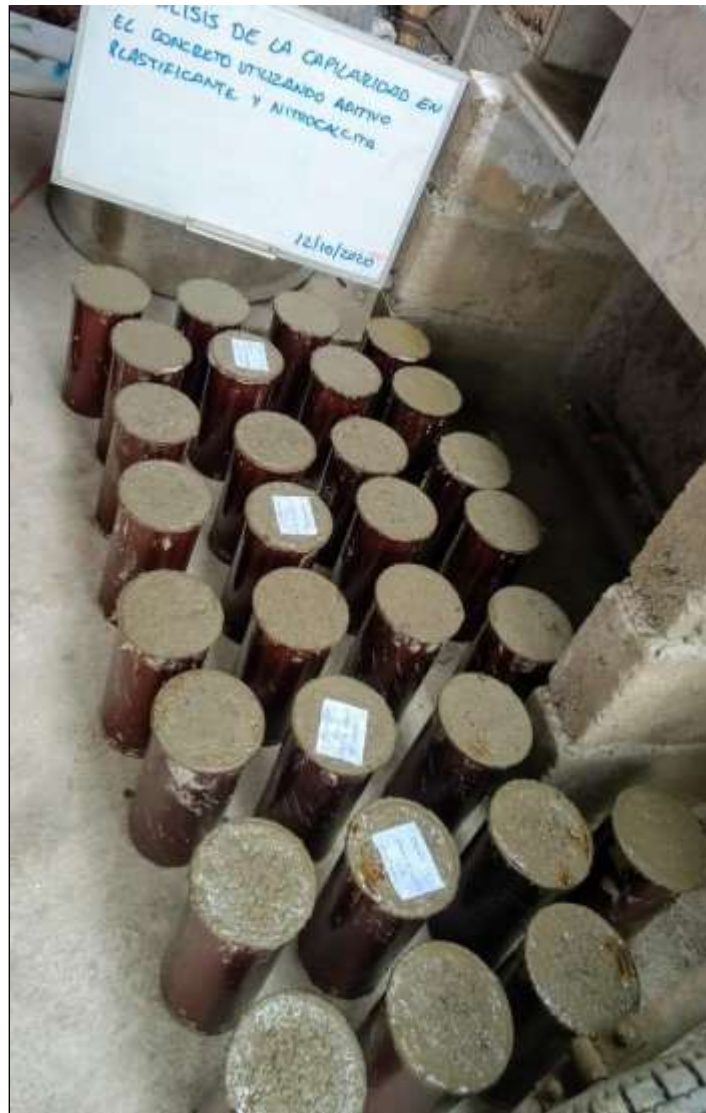
Figura 3. Elaboración de probetas de concreto.
