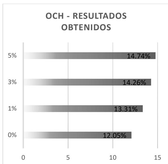
*Figura 19.* Óptimo contenido de humedad con adición de CCC en 0%, 1%, 3% y 5% según Guerra
