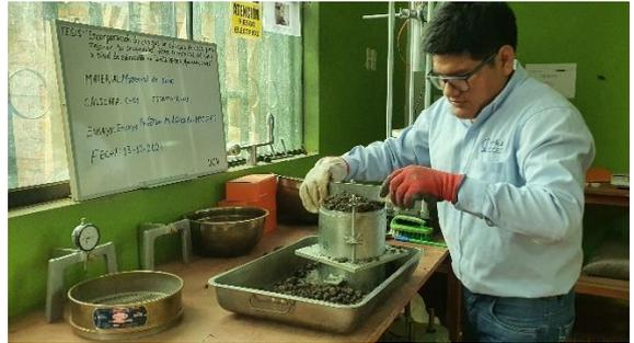
**Fotografía 36.** Procedimiento de ensayo Proctor de un suelo
