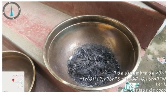
Fotografía 24. Obtención de cenizas de cáscara de coco
