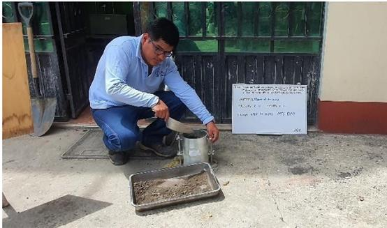
**Fotografía 37.** Procedimiento de ensayo CBR de un suelo
