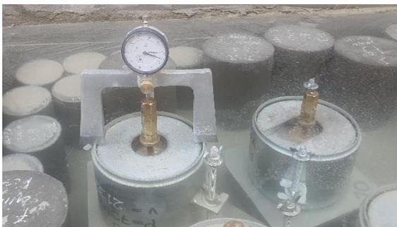
**Fotografía 39.** Procedimiento de ensayo CBR de un suelo
