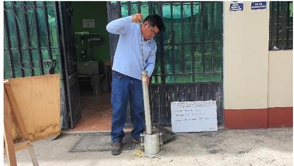
**Fotografía 38.** Procedimiento de ensayo CBR de un suelo
