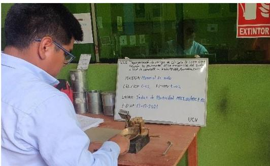
**Fotografía 31.** Determinación del límite líquido de un suelo
