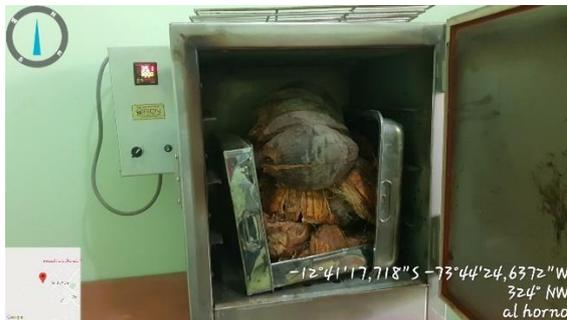
Fotografía 23. Calcinación de coco en horno eléctrico
