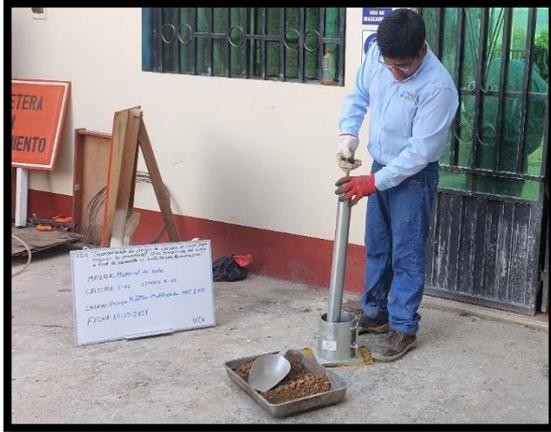
Figura 8. Compactación en el ensayo de Proctor modificado
