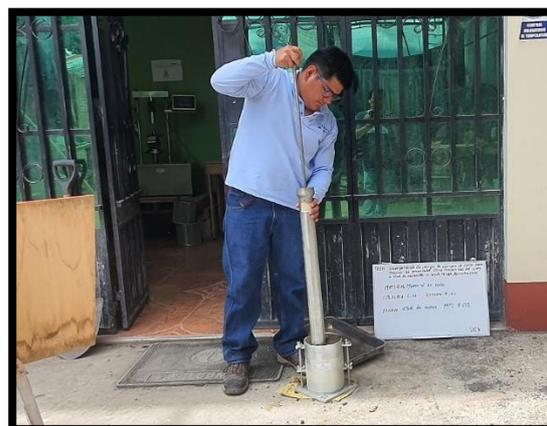
Figura 12. Compactación en el ensayo de Proctor modificado
