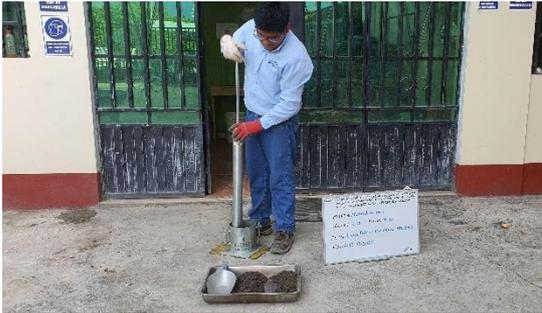
**Fotografía 35.** Procedimiento de ensayo Proctor de un suelo
