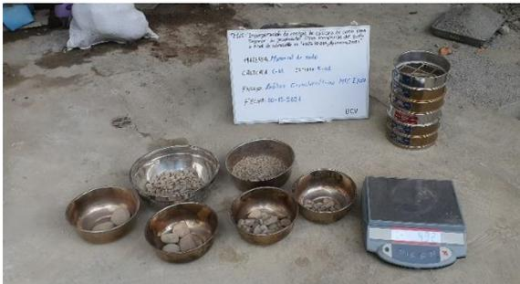
**Fotografía 28.** Análisis granulométrico por tamizado de un suelo
