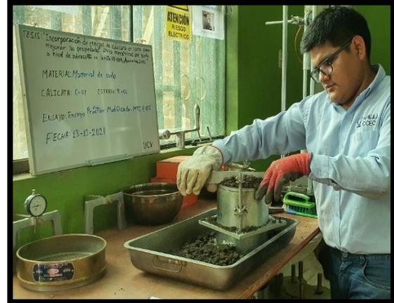
Figura 9. Enrasado después de la compactación en el ensayo de Proctor modificado
