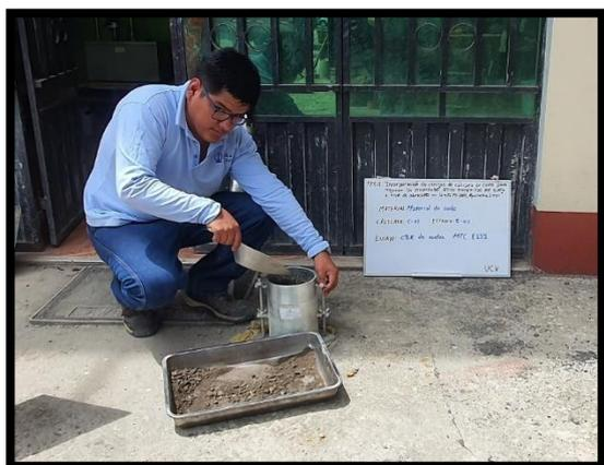
Figura 11. Compactación en el ensayo de Proctor modificado
