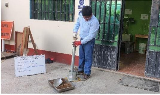
**Fotografía 33.** Procedimiento de ensayo Proctor de un suelo
