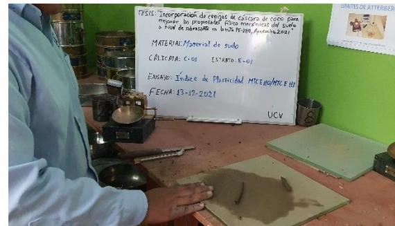
**Fotografía 30.** Determinación del límite plástico de un suelo
