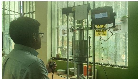
**Fotografía 40.** Procedimiento de ensayo CBR de un suelo
