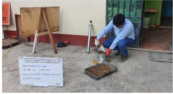
**Fotografía 34.** Procedimiento de ensayo Proctor de un suelo
