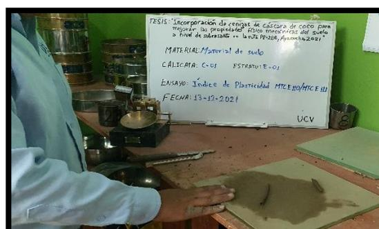
Figura 6. Determinación del límite plástico
