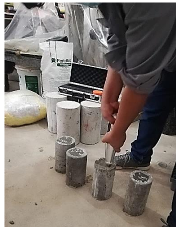
Figura 13. Accionar del embolo y se toma la lectura correspondiente.
