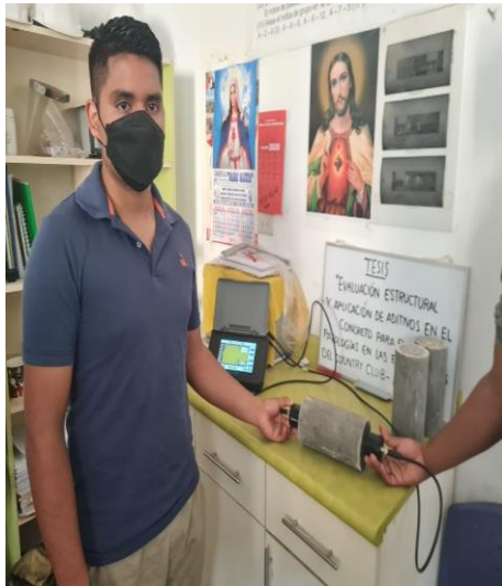
Figura 31. Medición de la velocidad de pulso ultrasónico.
