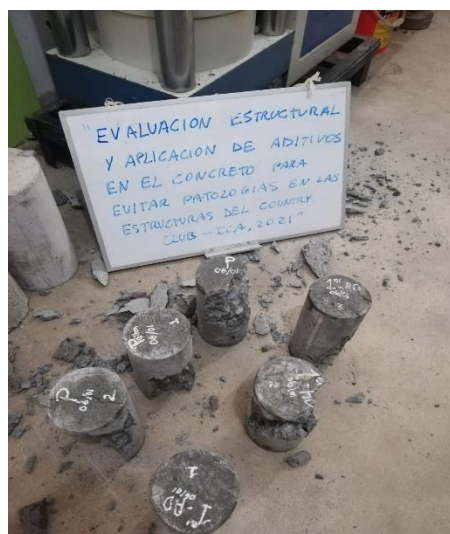
Figura 36. Las muestras y sus tipos de fallas respectivamente.
