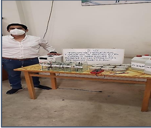
Foto 19: Ensayo de la penetración del Ion de cloruro
