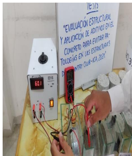
Figura 40. Toma de lecturas de las muestras expuestas a cloruros.
