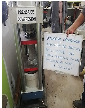
Figura 14. Colocación de probeta en prensa de compresión.
