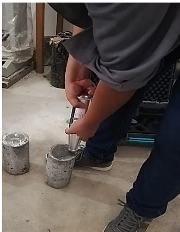
Figura 12. Colocación del esclerómetro en posición vertical.
