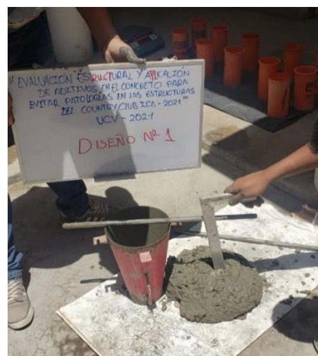
Figura 28. Se procede a medir el asentamiento.
