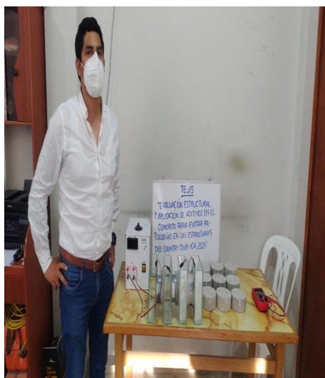
Figura 39. Ensayo a la penetración del ion cloruro.
