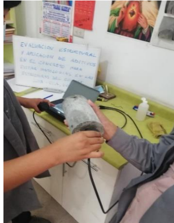
Figura 10. Colocación de transductores en la superficie plana de la probeta.
