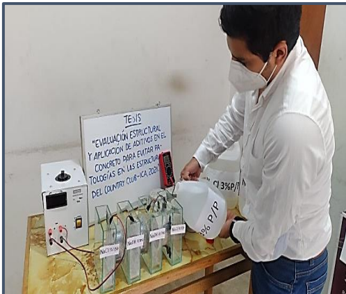
Foto 21: Ensayo de la penetración del Ion de cloruro
