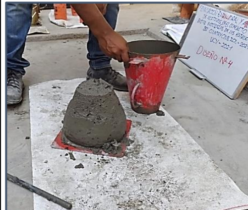
Foto 16: Ensayo de asentamiento del concreto
