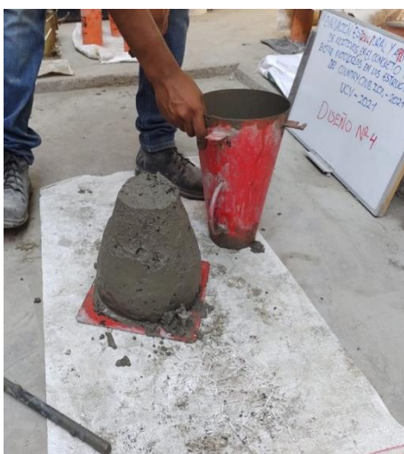
Figura 27. Se retira el cono metálico de Abrams.
