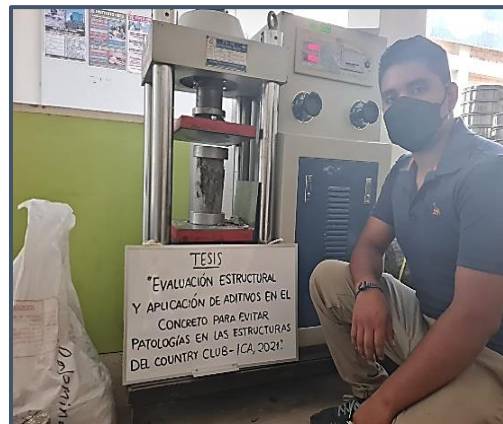
Foto 24: Ensayo de resistencia a la compresión
