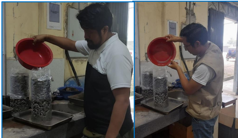
Figura N° 25: Infiltración del agua en el concreto con y sin aditivo de la miel de caña de azúcar.
