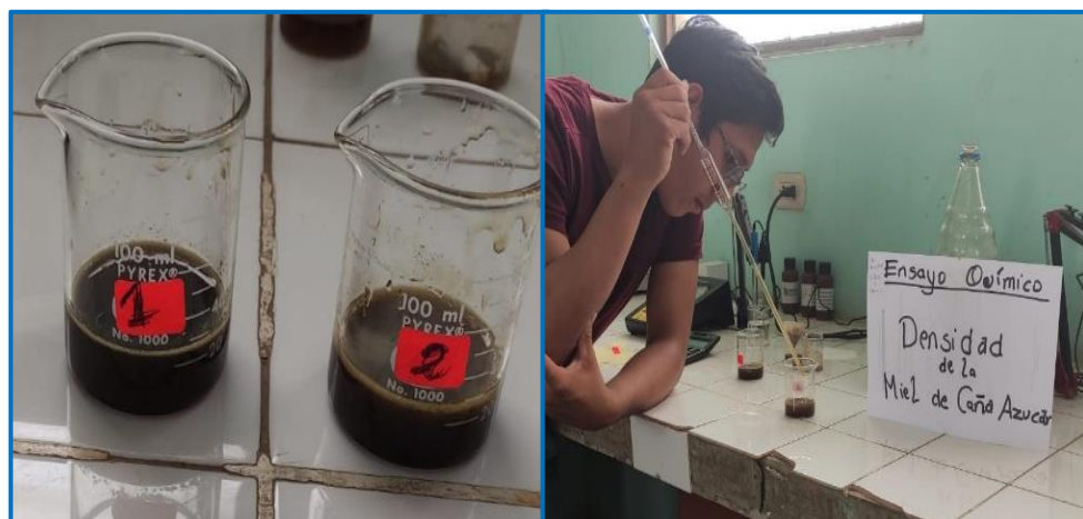
Figura N° 16: Ensayo de la densidad volumétrica
