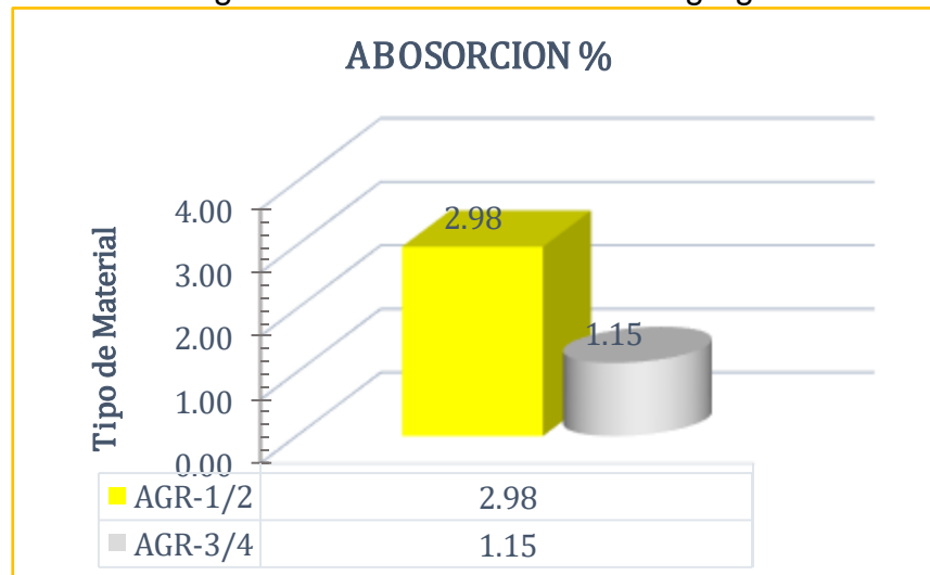
Figura N° 38: Absorción de los agregados
