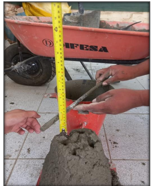
Imagen 10 y 11: Preparación de mezcla de concreto con adición de lana de
