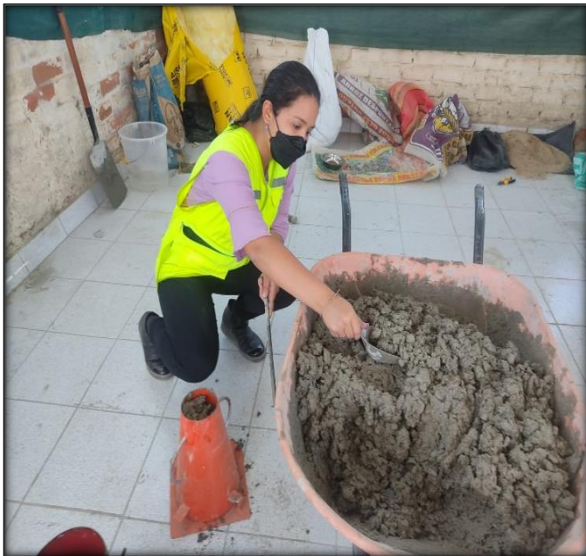
Imagen 10 y 11: Preparación de mezcla de concreto con adición de lana de
