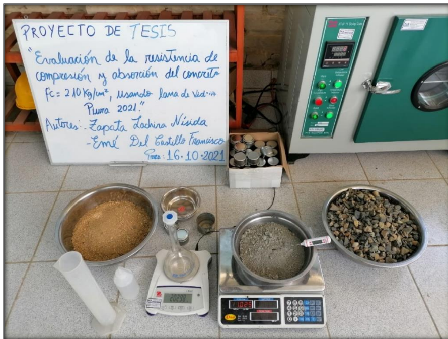
Imagen 6: Materiales y equipo para ensayo de pesos específicos y absorción de los agregados
