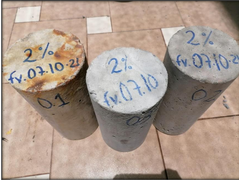
Imagen 17: Probetas de concreto con adición de 2% de lanas de vidrio, edad 7 días
