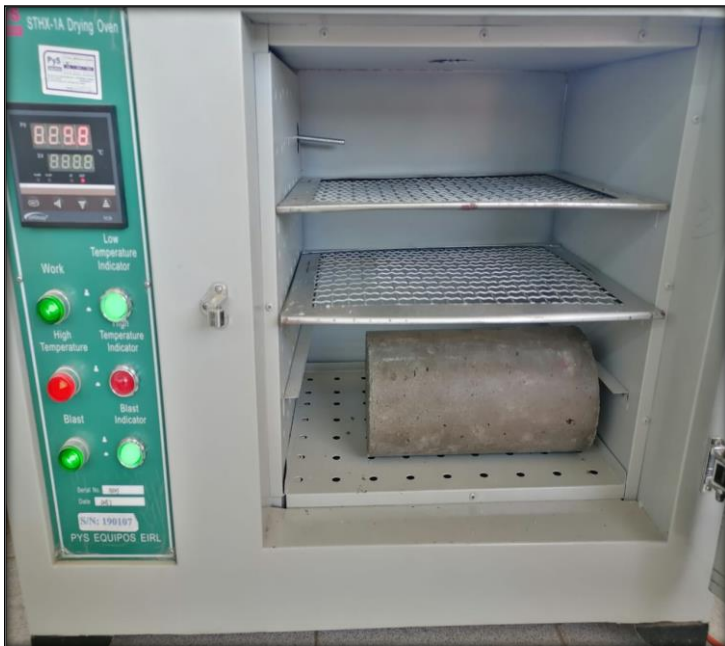
Imagen 23 y 24 Pesaje del espécimen seca en horno
