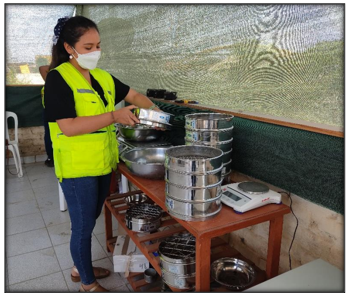
Imagen 3 y 4 Ensayo de granulometría, pesaje de cantidades retenidas.
