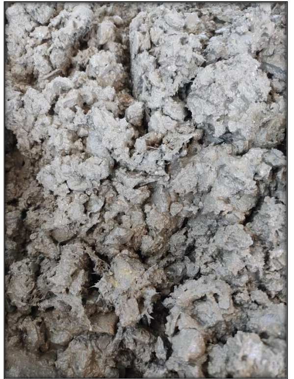
Imagen 10 y 11: Preparación de mezcla de concreto con adición de lana de
