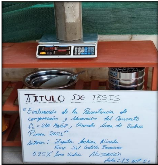
Imagen 21 y 22 Pesaje de muestra superficialmente seca para el ensayo de absorción
