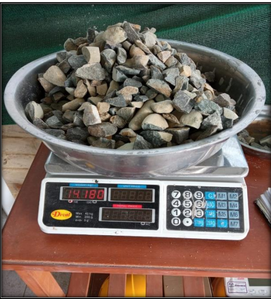
Imagen 3 y 4 Ensayo de granulometría, pesaje de cantidades retenidas.
