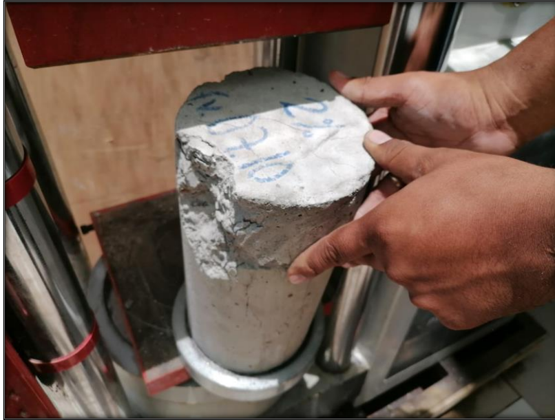
Imagen 19: Probeta con adición de 2% de lana de vidrio sometida a evaluación de la resistencia a la compresión
