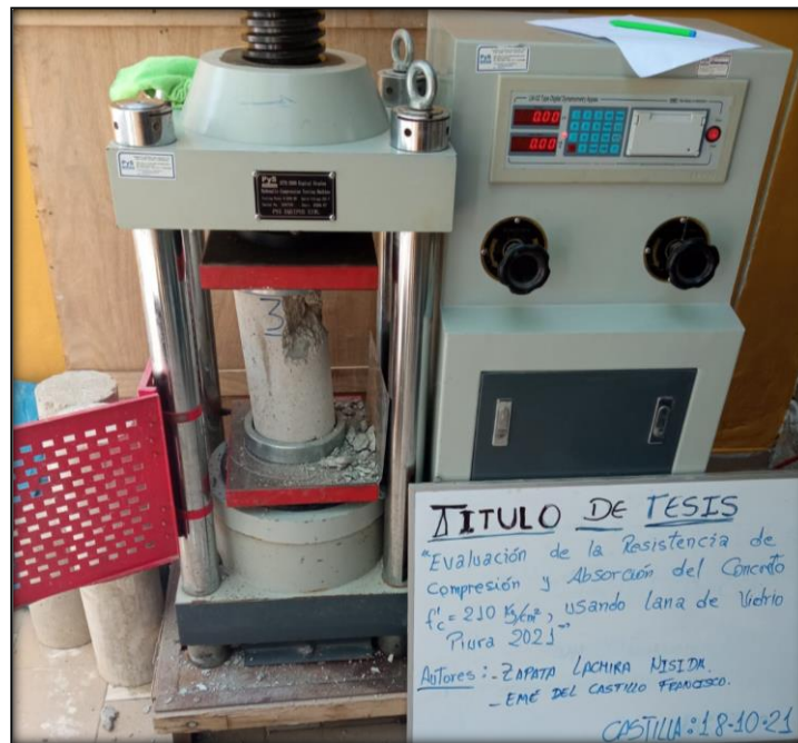
Imagen 20. Probeta sometida a evaluación de la resistencia a la compresión
