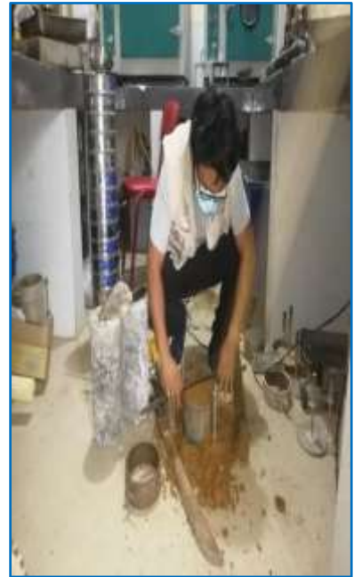
Fotografía N°11: Proctor Modificado + Incorporación de Áridos Gruesos Reciclados 10%, 15% y 20% Calicata 2
