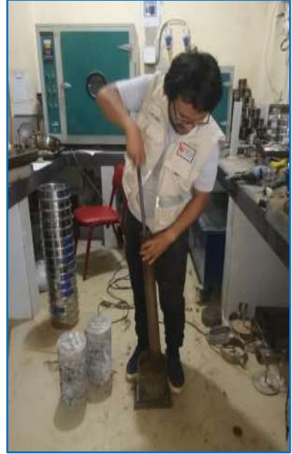
Fotografía N°10: Proctor Modificado + Incorporación de Áridos Gruesos Reciclos 10%, 15% y 20% Calicata 1
