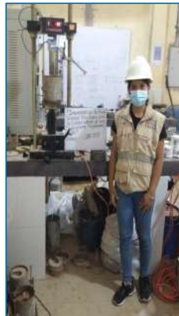
Fotografía N°12: CBR + Incorporación de Áridos Gruesos Reciclados 10%, 15% y 20% Calicata 1
