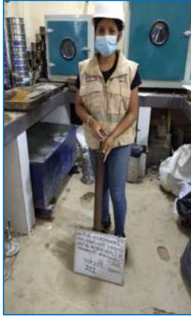
Fotografía N°11: Proctor Modificado + Incorporación de Áridos Gruesos Reciclados 10%, 15% y 20% Calicata 2
