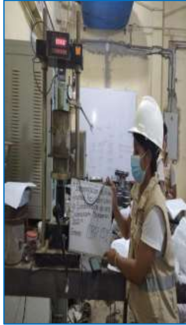
Fotografía N°12: CBR + Incorporación de Áridos Gruesos Reciclados 10%, 15% y 20% Calicata 2
