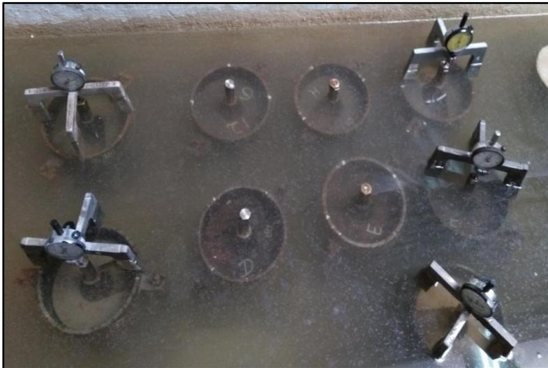
Muestra sumergida a las 96 horas para comprobar materiales expansivos.
