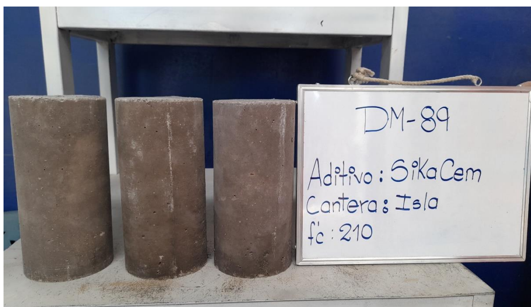
Probetas de concreto con aditivo SikaCem Acelerante PE
