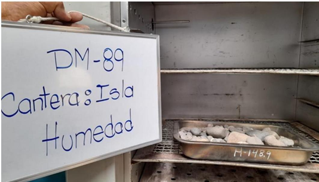
Ensayos de contenido de humedad
