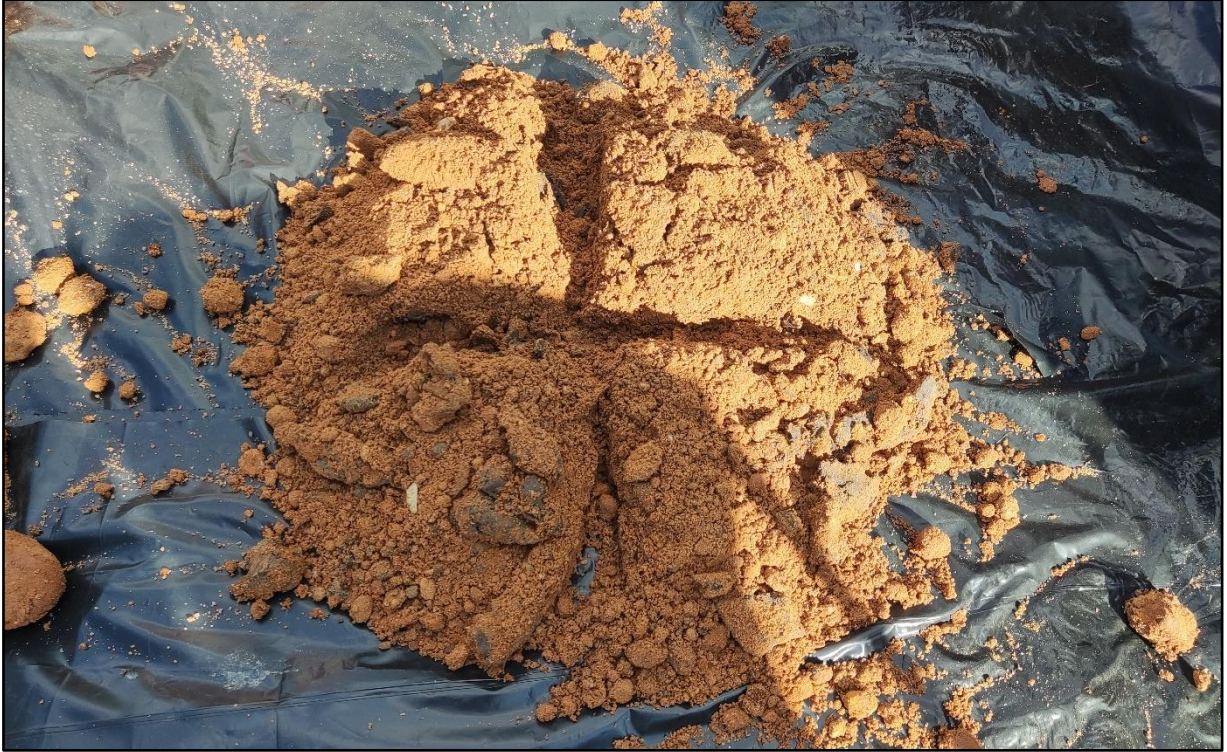
Método del cuarteo para la obtención de la muestra de suelo. Fuente: Elaboración propia, 2021.
