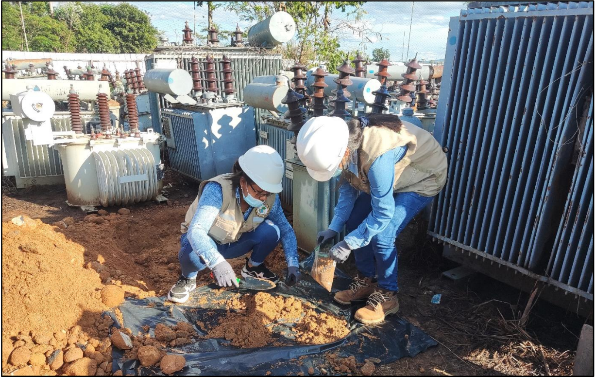
Obtención de la muestra para determinación de los BPC. Fuente: Elaboración propia, 2021.
