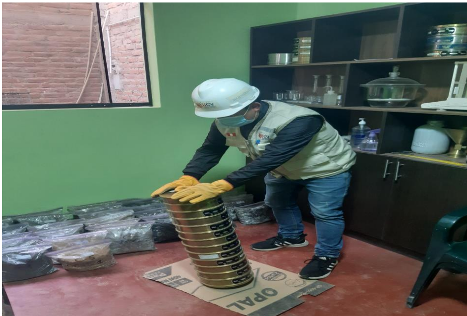
Foto 6. Ensayo de granulometría
