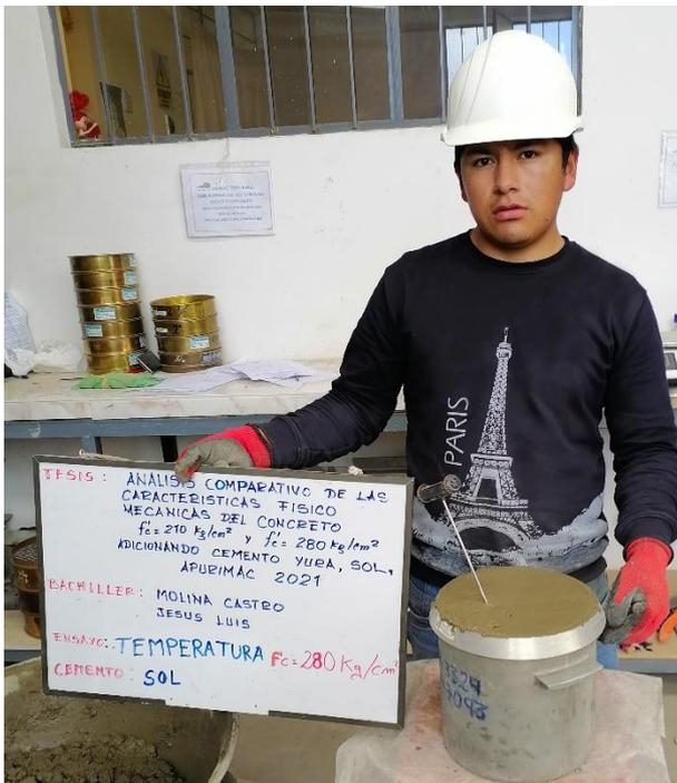
**Fotografía 07:** Determinación de la temperatura del concreto
