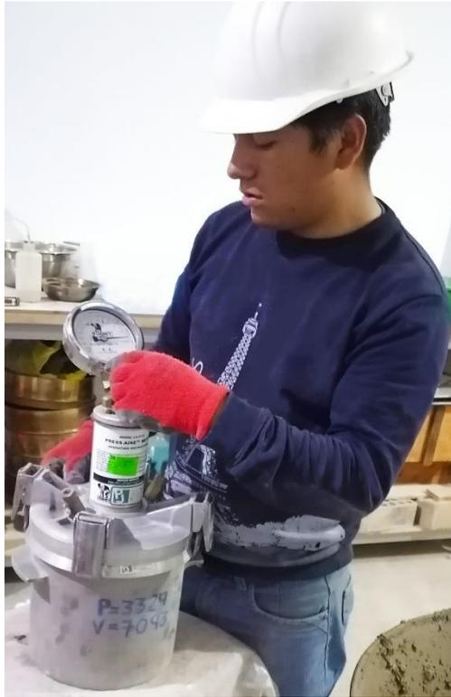
**Fotografía 09:** Determinación del contenido de aire del concreto
