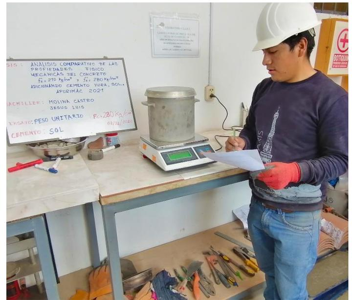
**Fotografía 08:** Determinación del peso unitario del concreto
