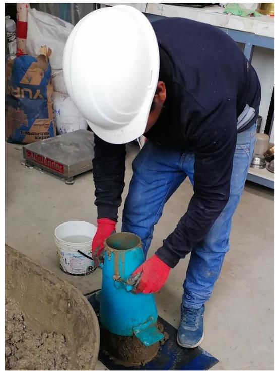
**Fotografía 06:** Determinación de Slump
