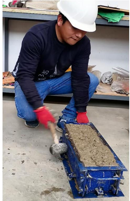
**Fotografía 10:** Elaboración de vigas de concreto
