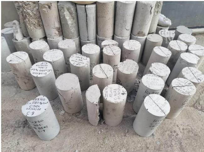
**Fotografía 09:** Ensayo resistencia a la compresión
