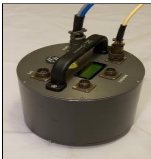
Figura 15: Instalación de una celda de asentamiento.
