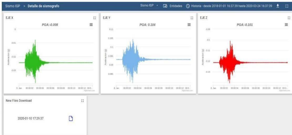
Figura 9. Dashboard acelerógrafos, con gráfica de acelerogramas en los tres ejes y la opción de descarga de datos del evento
