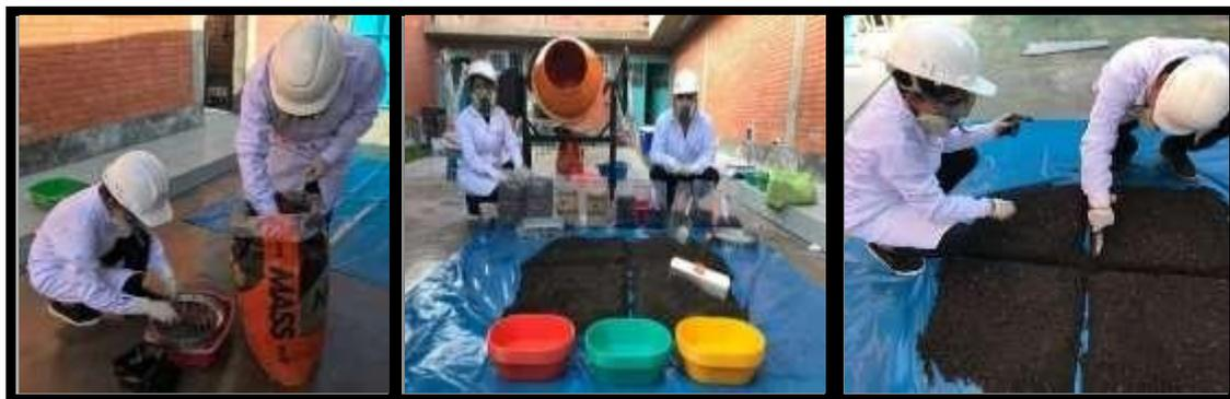
Figura 14: Tamizaje y homogenización del suelo
