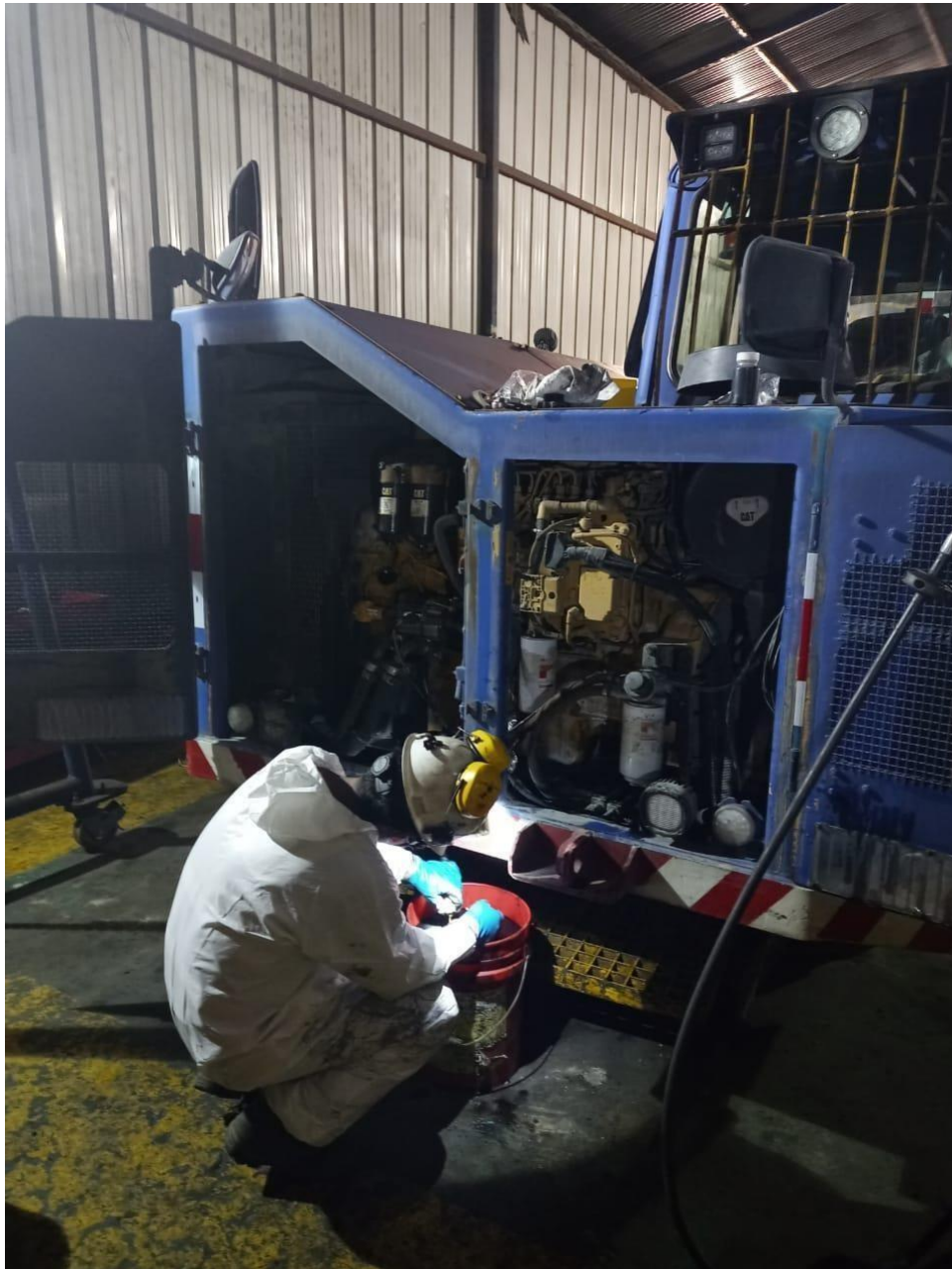
Figura 13. Mantenimiento de suministro de aceite hidráulico en MIXKRET
