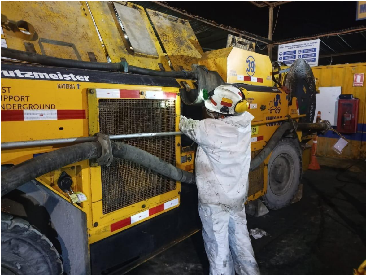
Figura 14. Mantenimiento de cambio de alternador eléctrico para equipo MIXKRET
