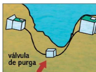
Figura 6. Válvula de purga
