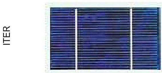
Panel formado con células de silicio policristalino
