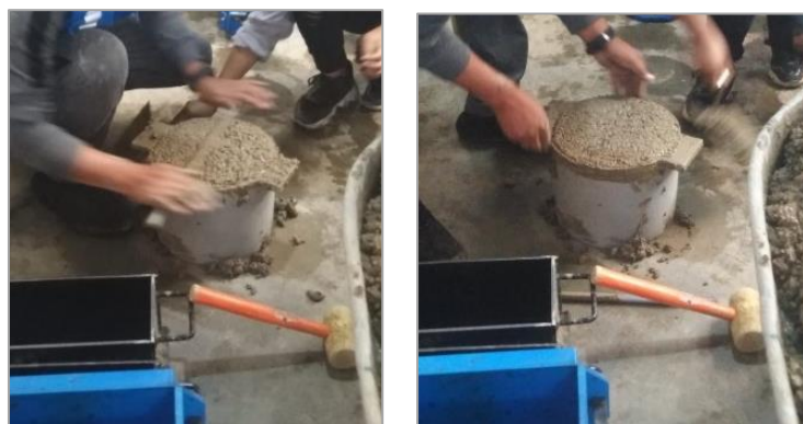
Figura N° 10. Medición del peso unitario del concreto en estado fresco mediante el uso de balde metálico normalizado.
