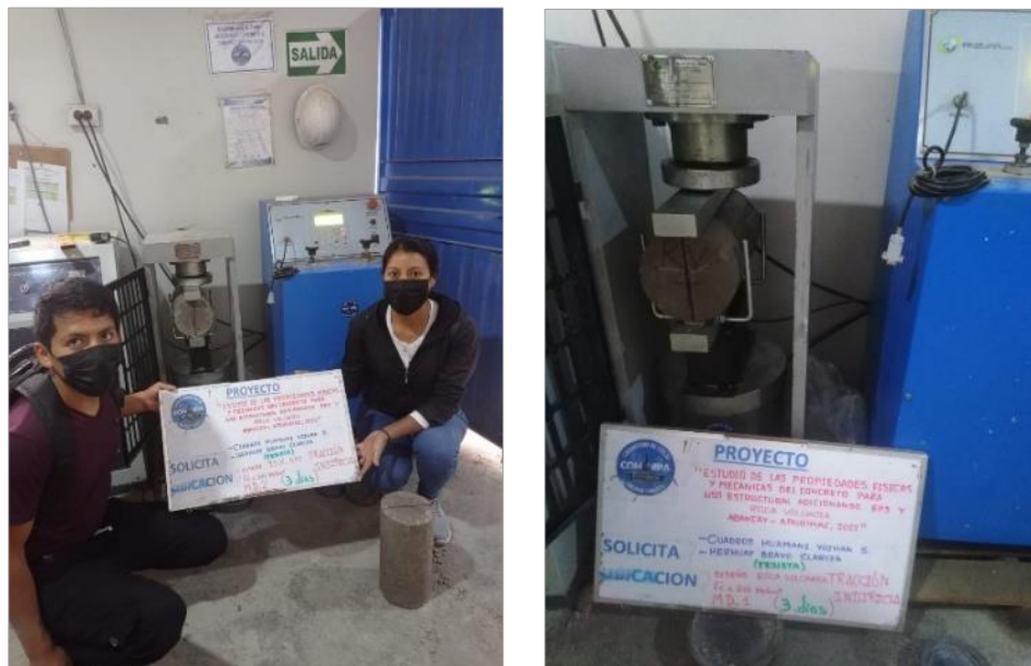
Figura N° 19. Ensayo de resistencia a la tracción por compresión diametral del concreto mediante el uso de una máquina hidráulica.
