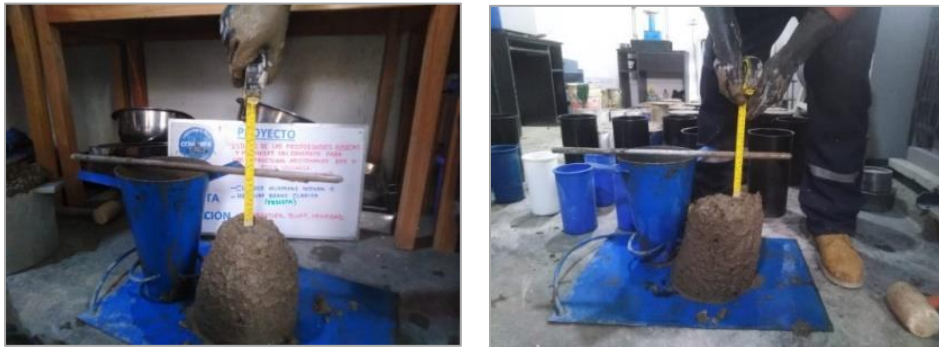
Figura N° 6. Medición del asentamiento del concreto con el uso del cono de abrams.
