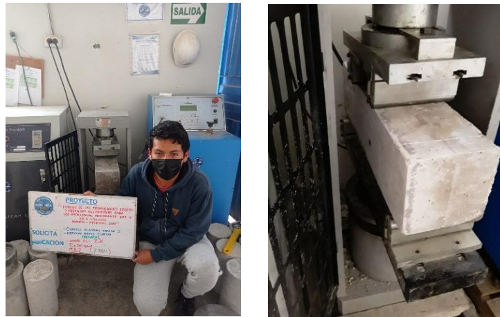
Figura N° 24. Ensayo de resistencia a la flexión de vigas del concreto mediante el uso de una máquina hidráulica.
