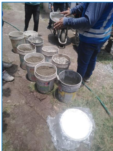
DOSIFICACION DE MATERIALES PARA ELABORACION DE LAS MUESTRAS
