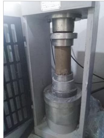
Figura N° 14. Ensayo de resistencia a la compresión axial del concreto mediante el uso de una máquina hidráulica.
