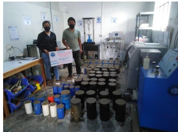
ELABORACION DE BRIQUETAS DE CONCRETO PARA ENSAYOS DE RESISTENCIA
