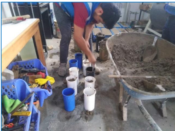
ELABORACION DE BRIQUETAS DE CONCRETO PARA ENSAYOS DE RESISTENCIA
