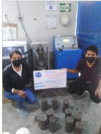
Figura N° 14. Ensayo de resistencia a la compresión axial del concreto mediante el uso de una máquina hidráulica.
