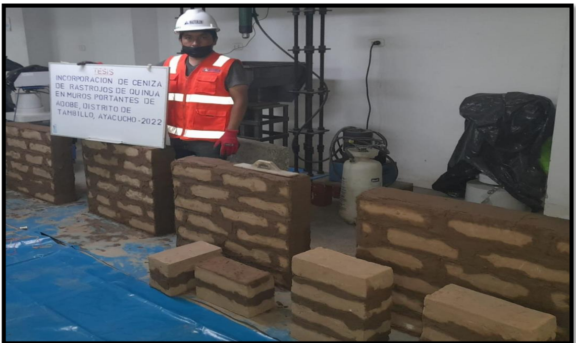
Figura 22: Elaboracion de Muretes y pilas de adobe para ensayo.
