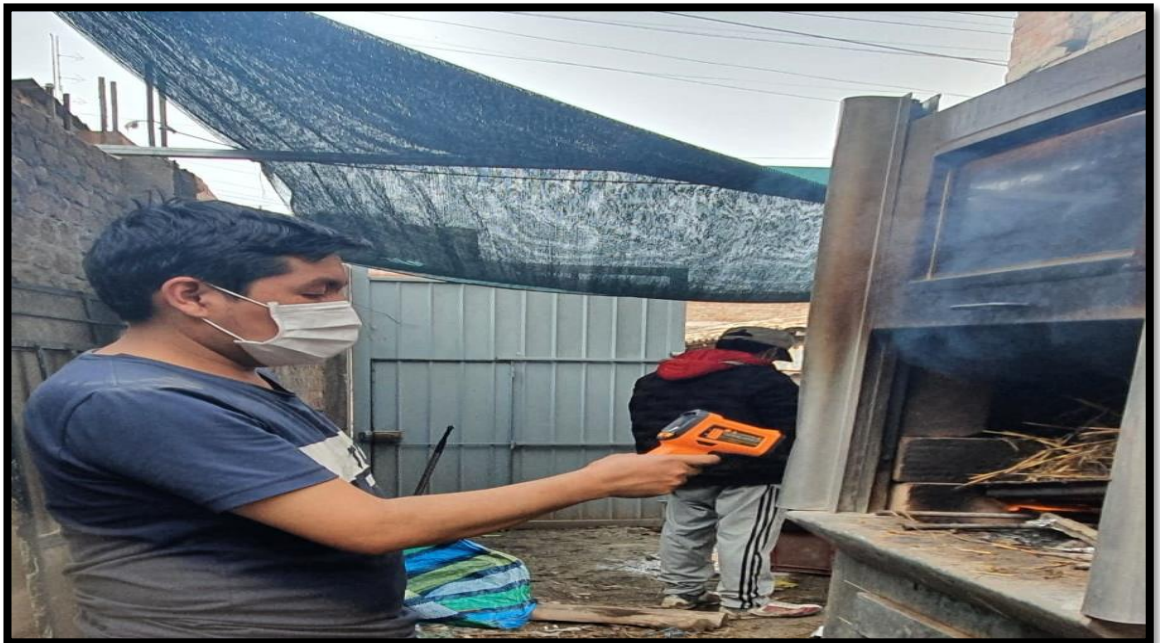
Figura 08: Incineracion en horno convencional, controlando la temperatura.
