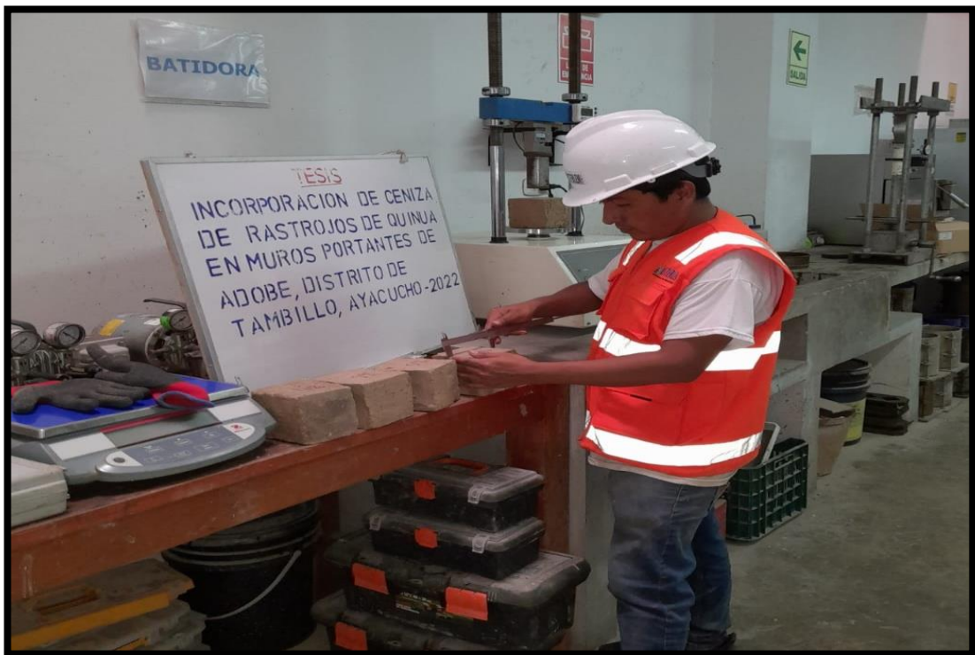
Figura 27: Ensayo de resistencia a la compresion en bloques.
