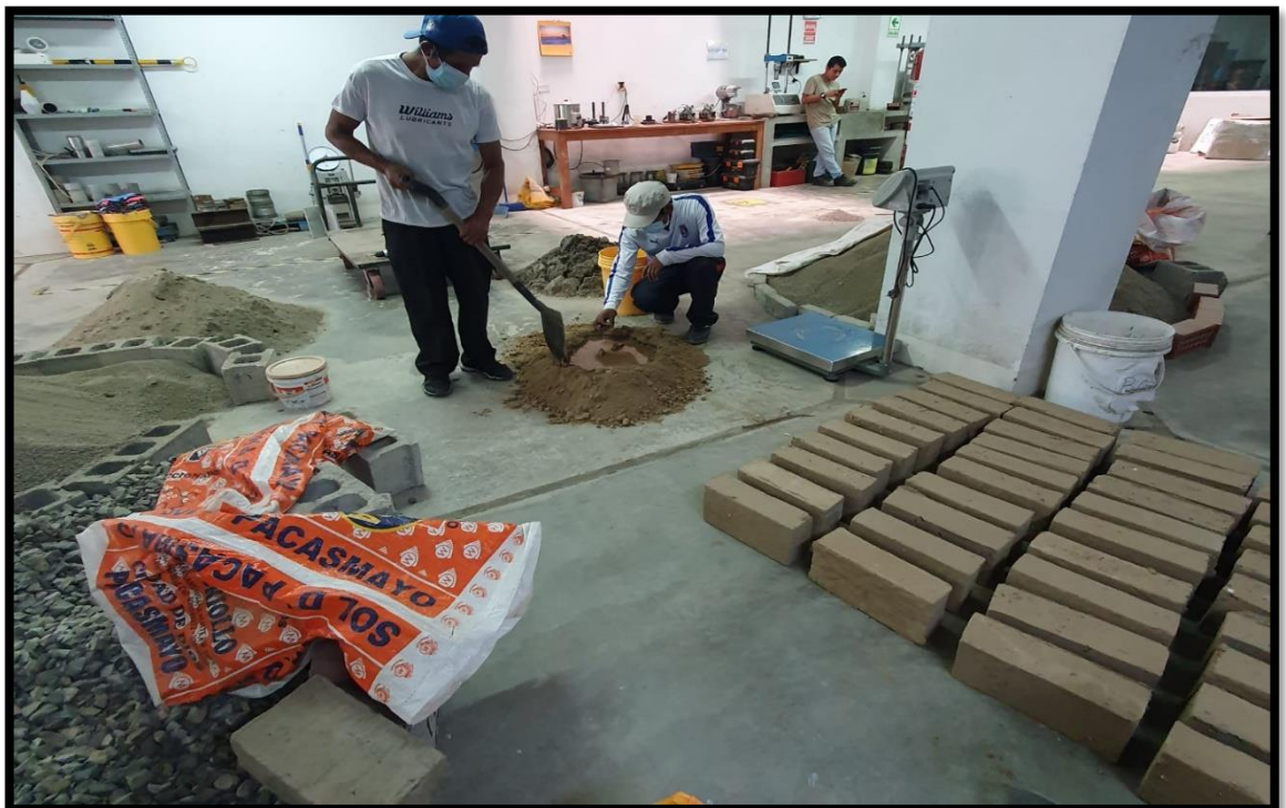
Figura 17: Elaboracion y secado de adobes de muestra patron
