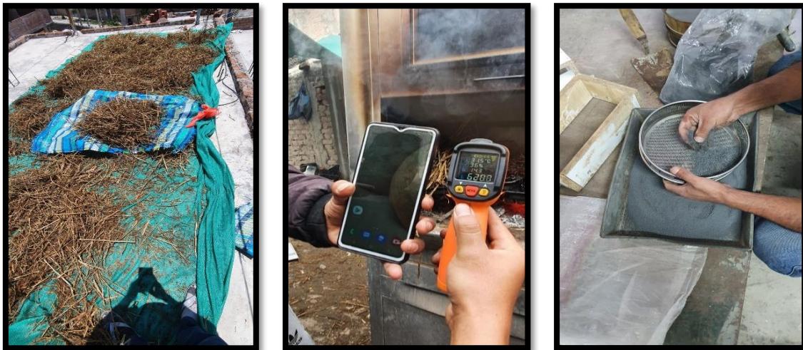
Figura 18 Secado, control de temperatura, tamizado de ceniza
