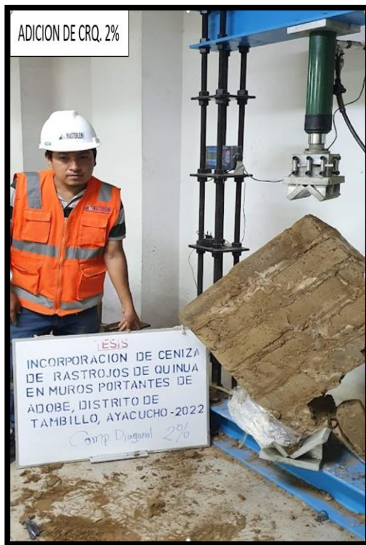
Figura 41: Ensayo de resistencia a la compresion diagonal de muretes de adobe 2% CRQ
