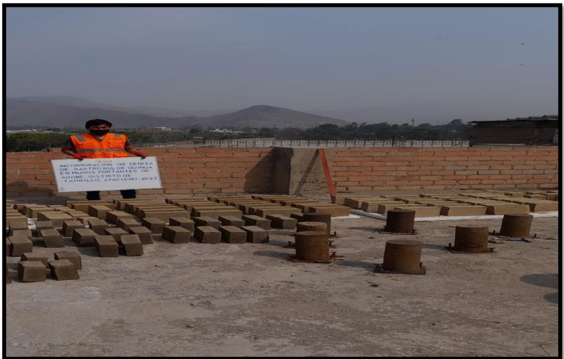
Figura 15: Elaboracion y secado de adobes de 9% de ceniza de rastrojos de quinua.
