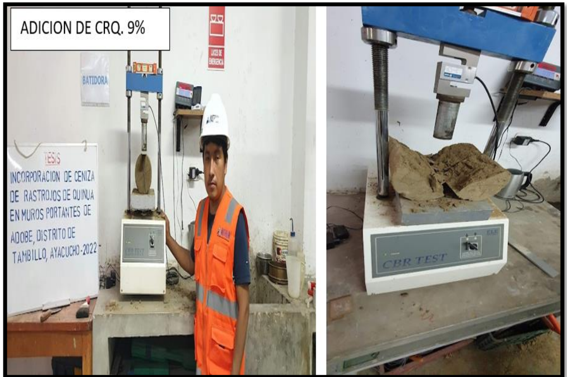
Figura 33: Ensayo de resistencia a la traccion indirecta
