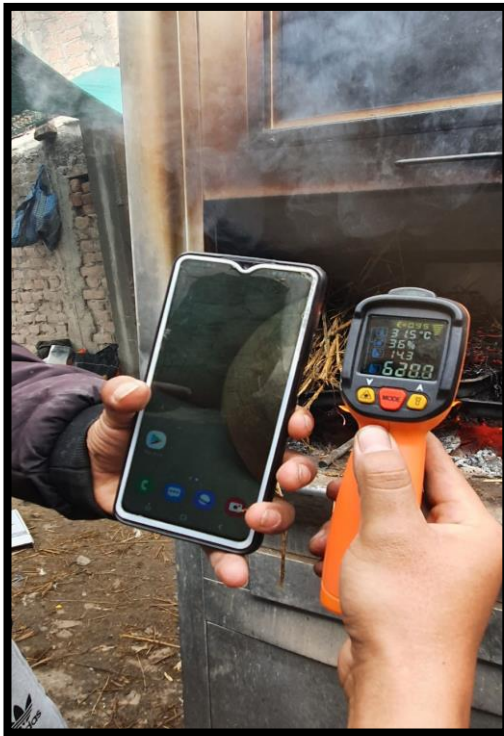
Figura 09: Control de temperaturas cada 10 minutos, para la calcinacion constante.
