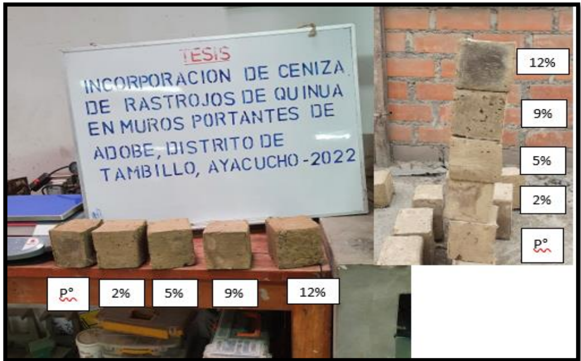
Figura 26: Ensayo de resistencia a la compresion en bloques.
