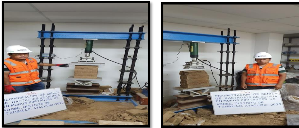
Figura 42. Ensayo de resistencia a la compresión en pilas de adobe
