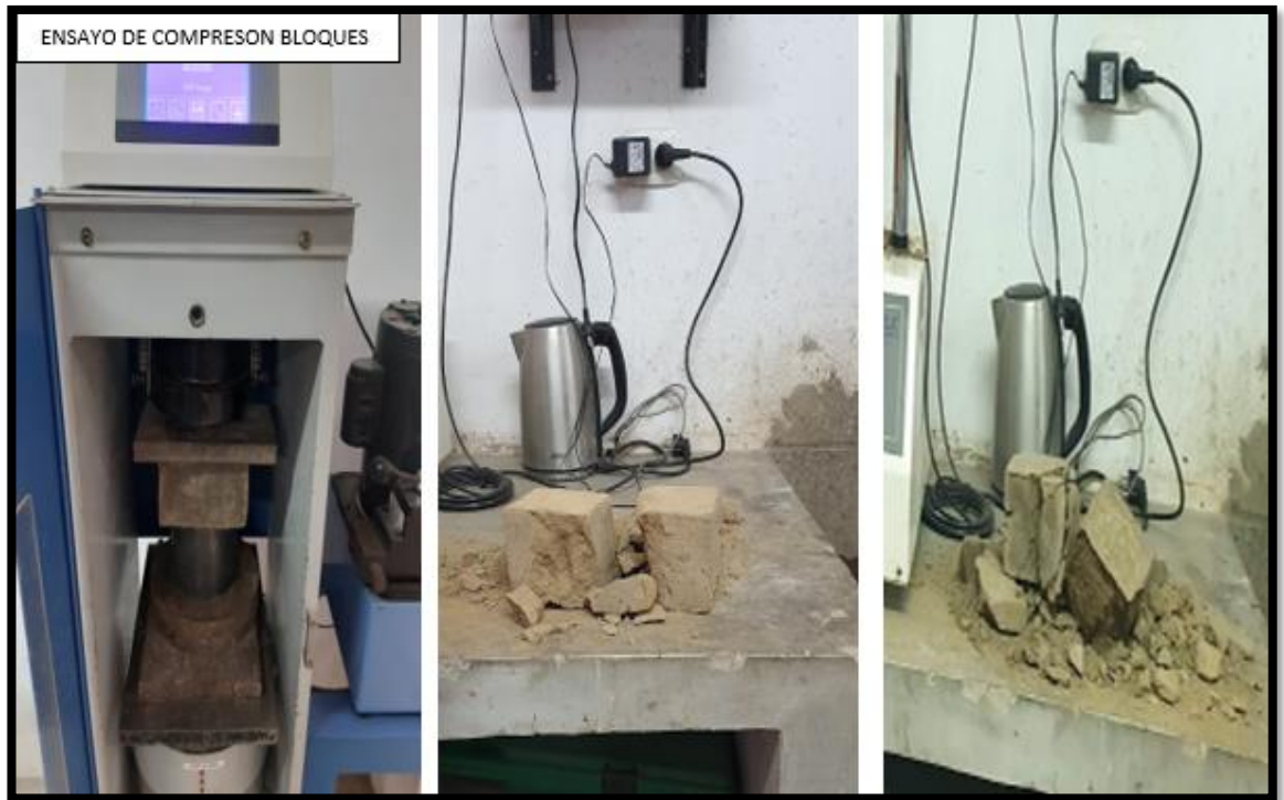
Figura 29: Ensayo de resistencia a la compresion en bloques.
