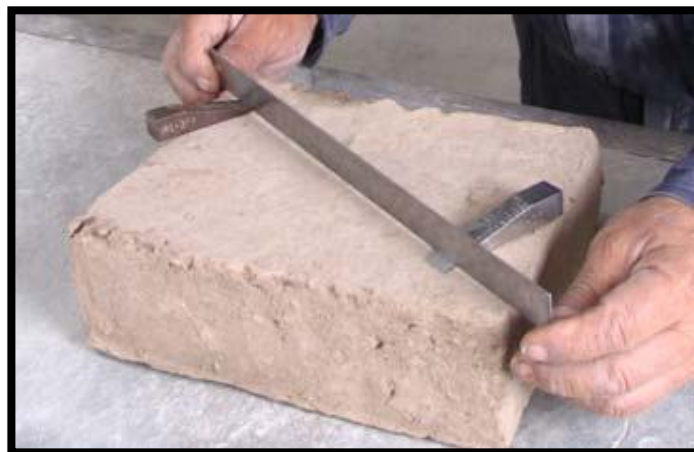
Figura 9 Prueba de alabeo de la unidad de adobe
