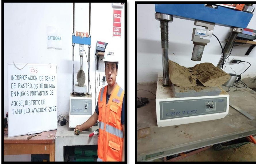
Figura 37 Ensayo de resistencia a la tracción en unidades de bloques.
