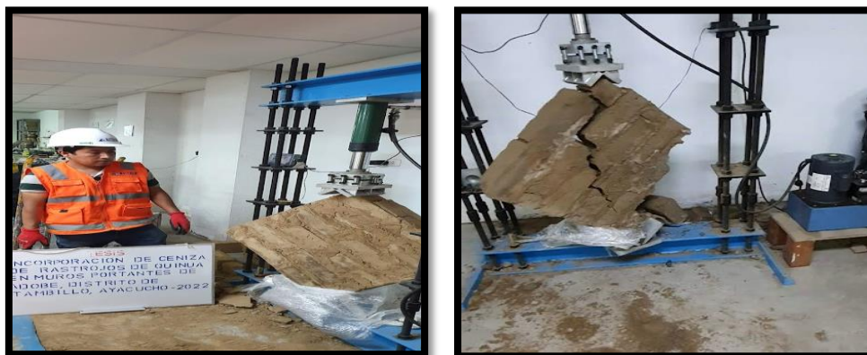
Figura 45 Ensayo de resistencia en muros a tracción indirecta
