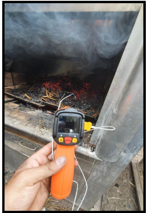
Figura 09: Control de temperaturas cada 10 minutos, para la calcinacion constante.
