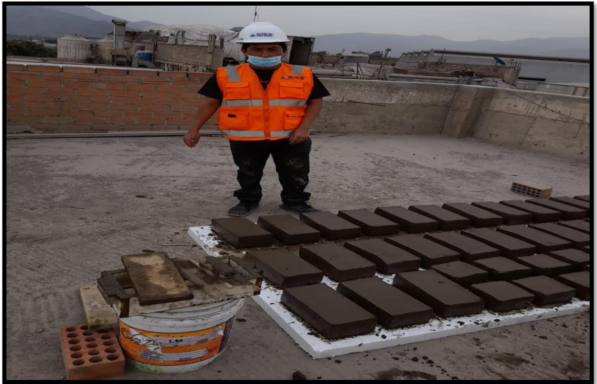
Figura 14: Elaboracion de adobes convensionales 12% de ceniza de rastrojos de quinua
