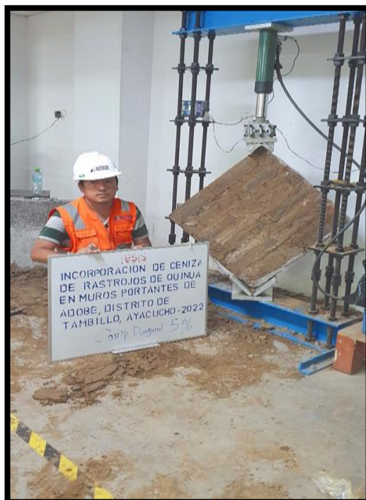
Figura 42: Ensayo de resistencia a la compresion diagonal de muretes de adobe 5% CRQ
