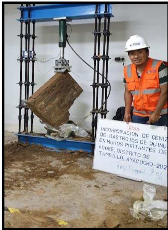
Figura 43: Ensayo de resistencia a la compresion diagonal de muretes de adobe 9% CRQ
