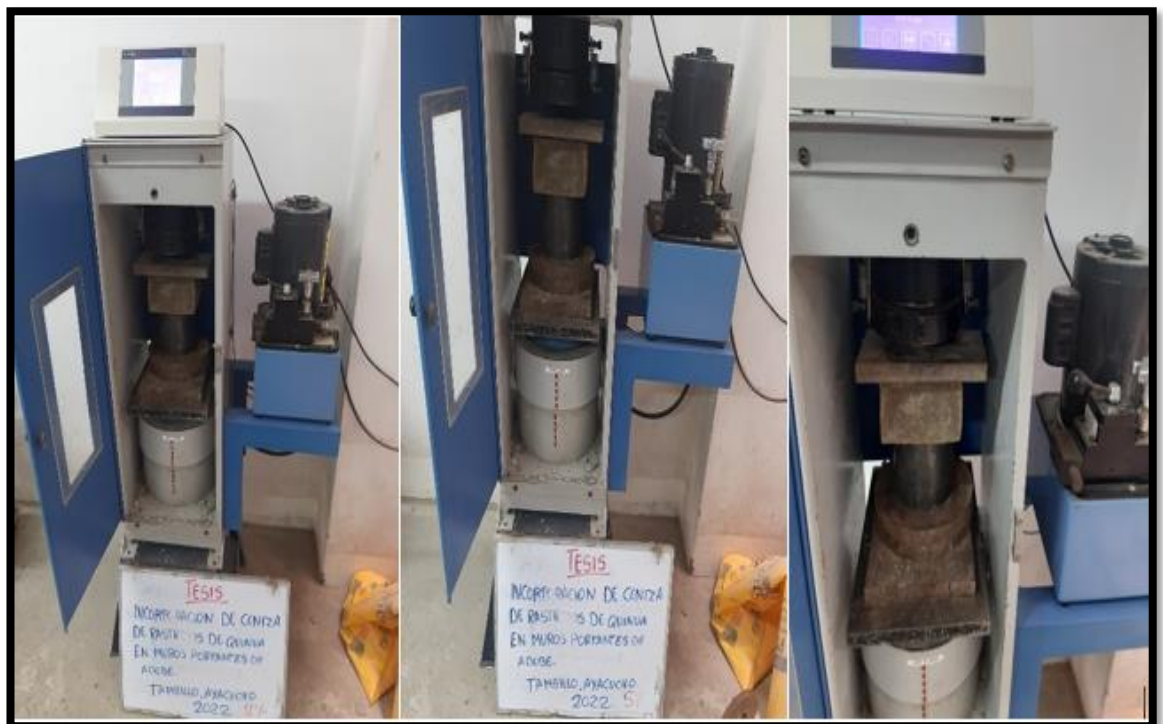
Figura 28: Ensayo de resistencia a la compresion en bloques.
