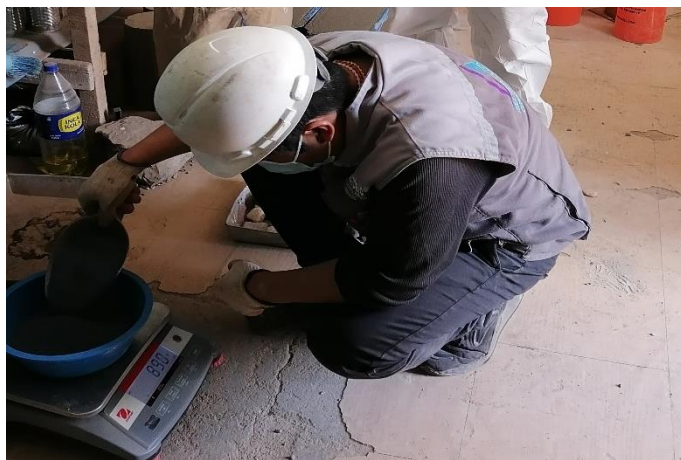
Pesaje del microsílíce a utilizar para la elaboración de probetas y prisma de concreto.
