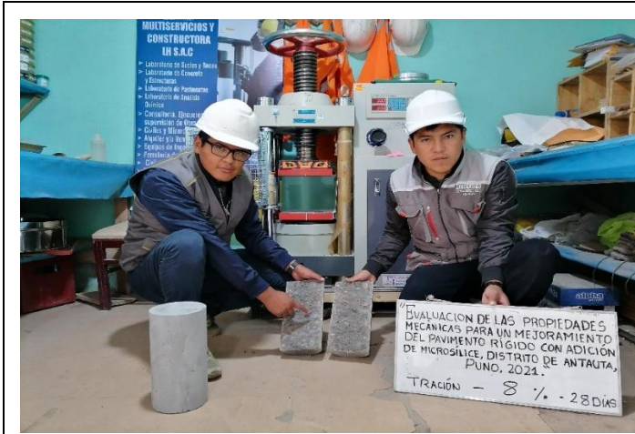
Verificación de la rotura de probeta.
