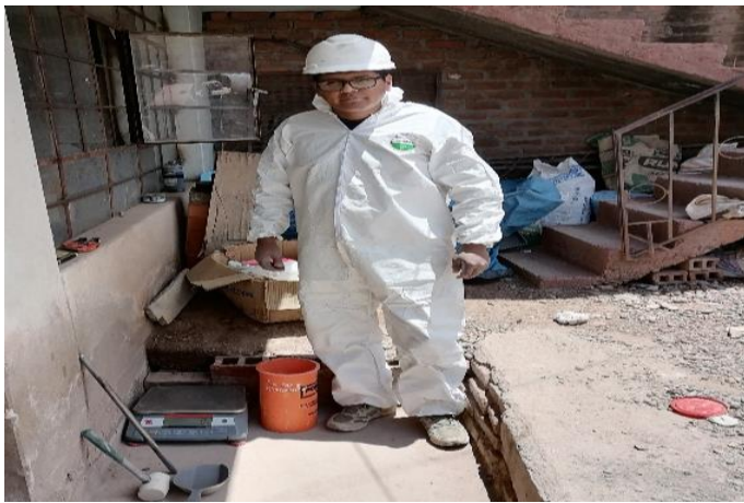
Equipos y herramientas para la toma del peso unitario del concreto fresco.
