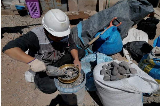
Clasificación de agregados, mediante el tamizado.
