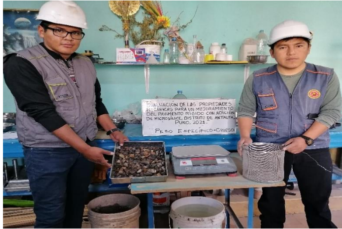
Ensayo de PESO ESPECÍFICO del agregado grueso.
