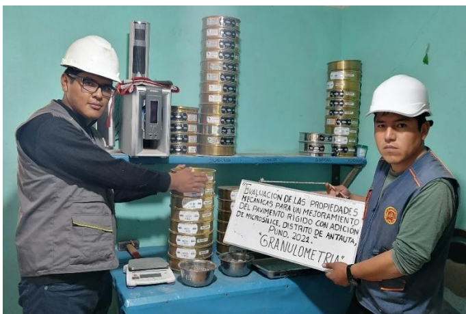
Tamizaje de los agregados para determinar la GRANULOMETRIA.
