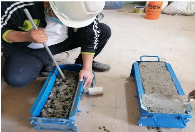
Elaboración del Prisma de concreto.
