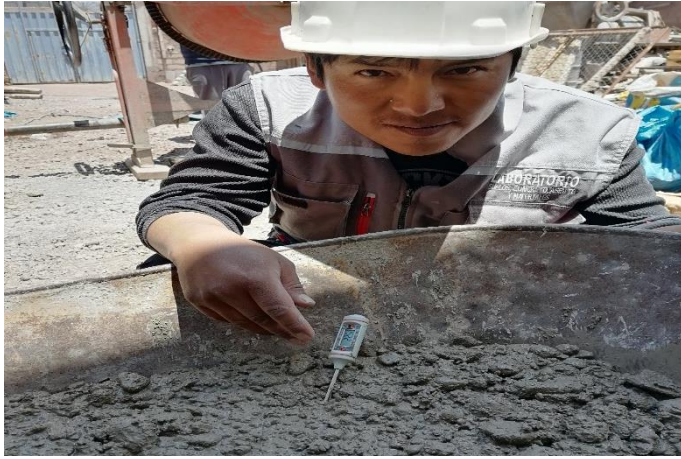
Medición de la temperatura del concreto fresco.
