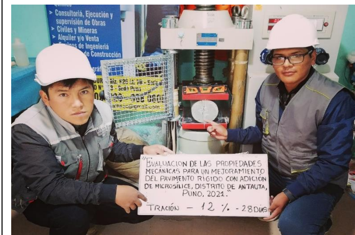
Determinación de la resistencia a la TRACCIÓN del concreto con adición de 12% del microsíllice, ensayo realizado a los 28 días, de acuerdo a la ASTM C496/C496M-17.
