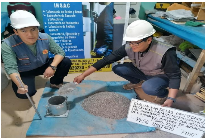
Ensayo de PESO UNITARIO del agregado fino.
