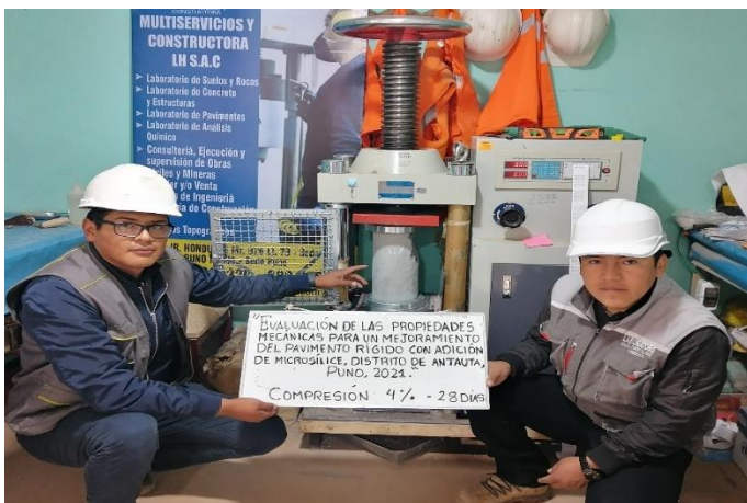
Determinación de la resistencia a la COMPRESIÓN del concreto con adición de 4% del microsílíce, ensayo realizado a los 28 días, de acuerdo a la ASTM C39/C39M-20
