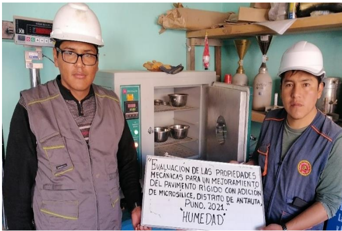
Secado en horno de los agregados para determinar el CONTENIDO DE HUMEDAD.
