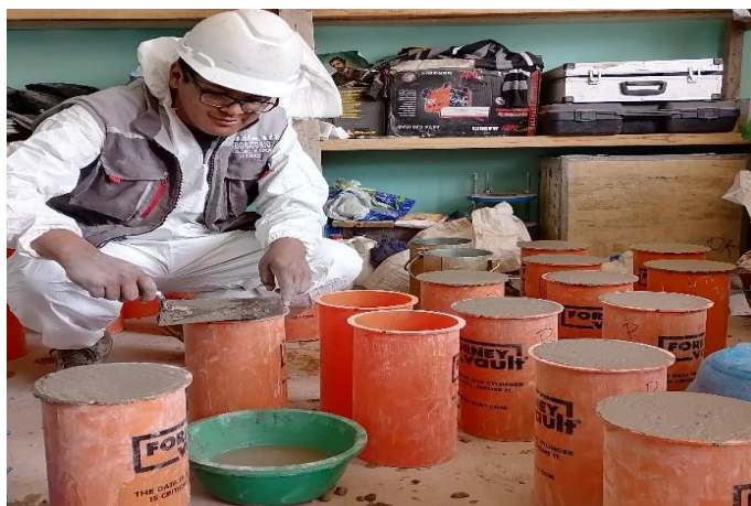
Elaboración de las probetas de concreto.
