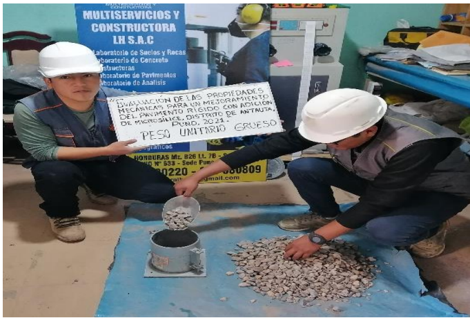
Ensayo de PESO UNITARIO del agregado grueso.
