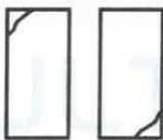
Tipo 5 Fracturas en los lados en las partes superior o inferior (ocurre comúnmente con cabezales no adheridos).
