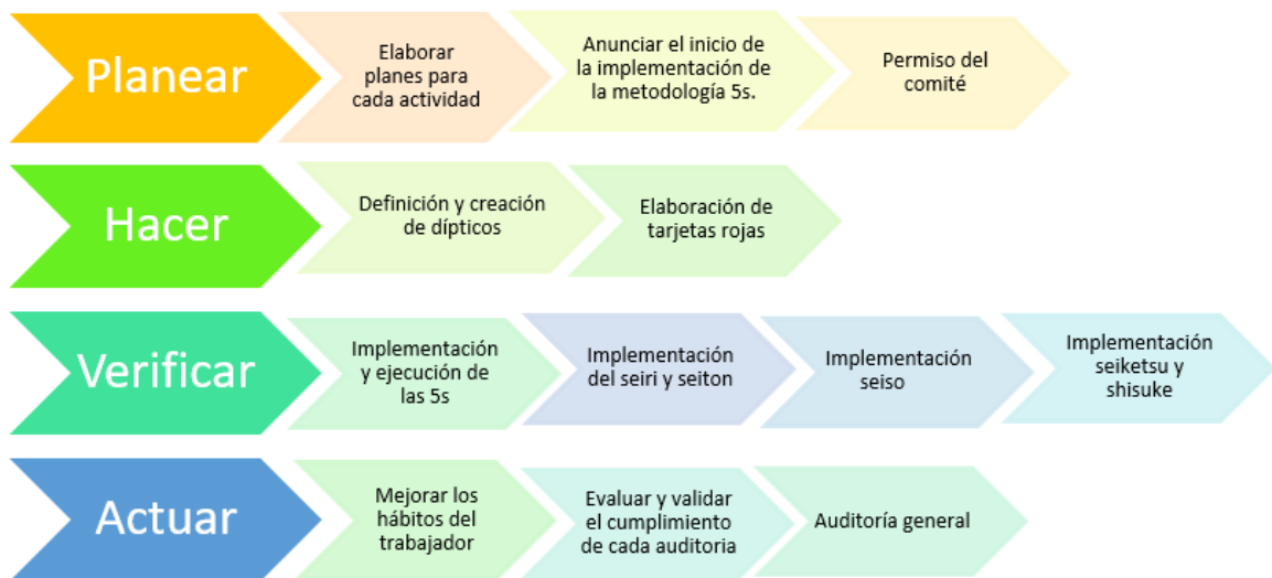
Figura 11. Etapas de la ejecución de la propuesta de mejora
