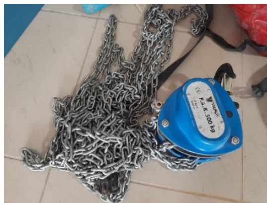
Figura 17. Equipo de izaje sin certificado de mantenimiento anual
