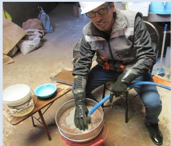
Fotografía 12 Eliminación de material de limos y arcillas.
