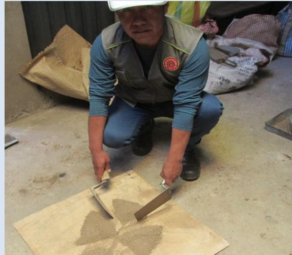
Fotografía 10 Cuarteo de agregado fino.
