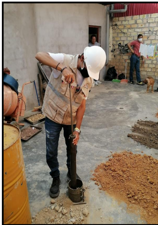
Figura 25: Procedimiento de los golpes para el analisis del Proctor Modificado.
