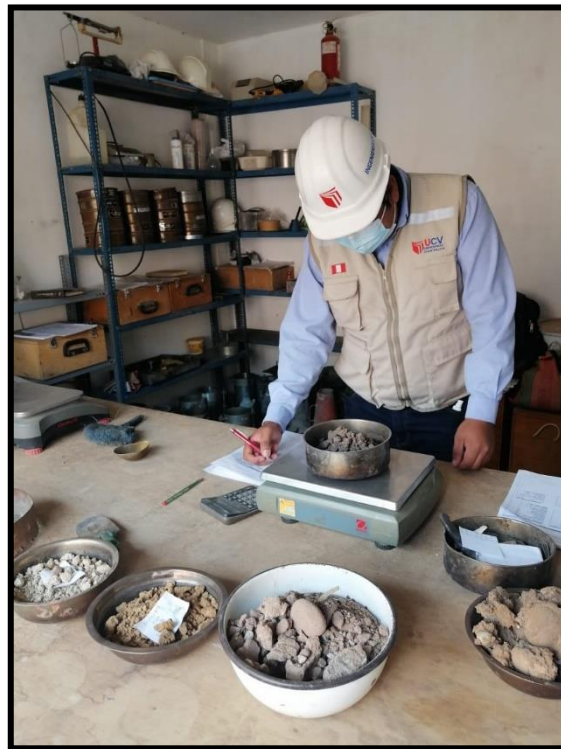
Figura 26: Procedimiento de pesado de cada muestra para determinar la estructura de la carpeta del pavimento.
