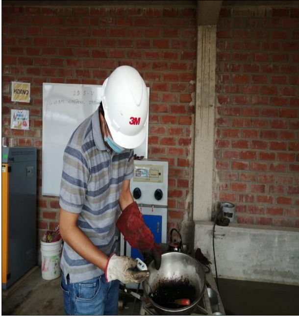
Control de temperatura de la mezcla
