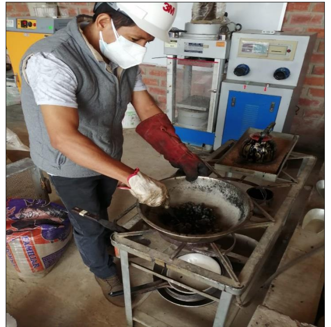
Mezcla de agregados y asfalto
