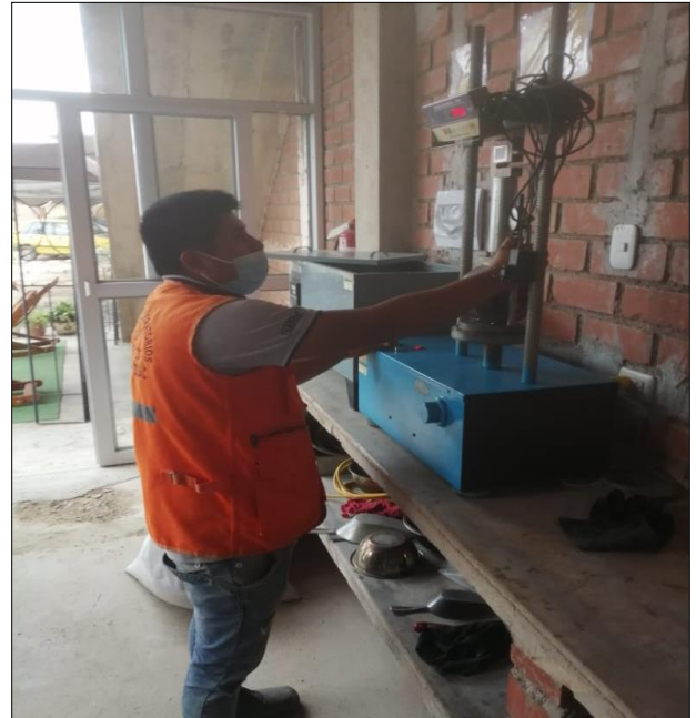
Rotura para encontrar Estabilidad y fujo
