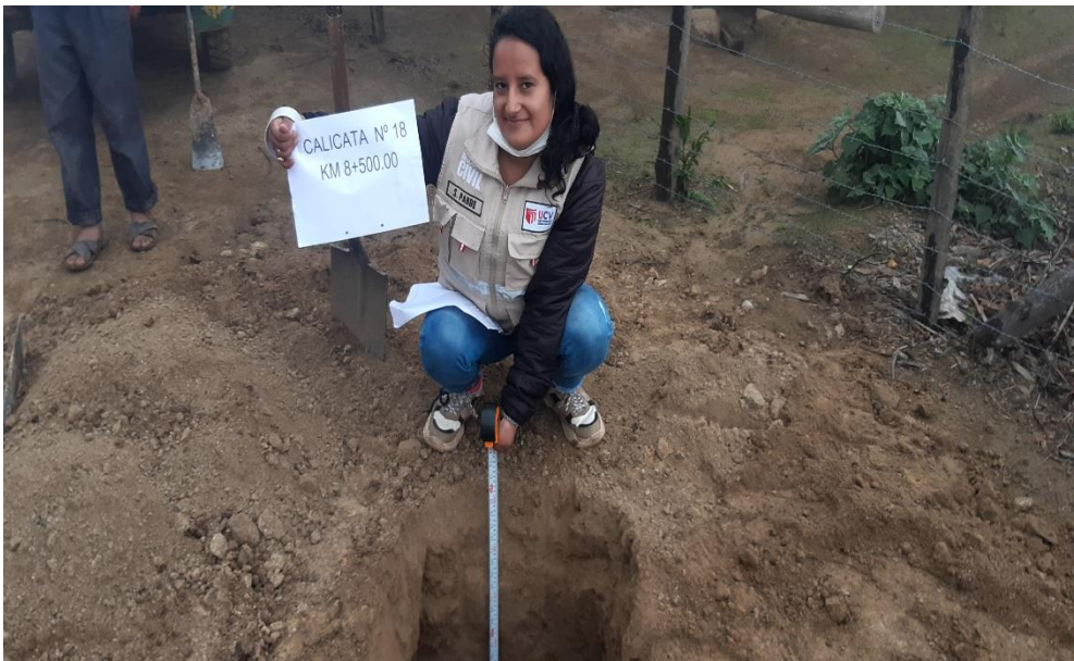
Figura 72. Verificación de la altura de la calicata N° 18
