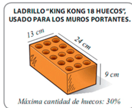
Figura 3 Configuración geométrica del ladrillo
