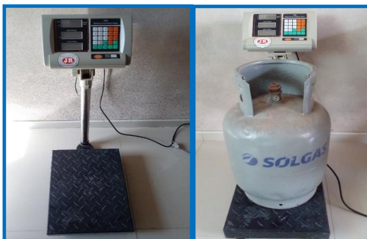
Figura 21: Pesado del balón de gas antes y después de tratamiento
