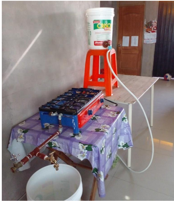
Sistema de calentador de agua antes de su funcionamiento
