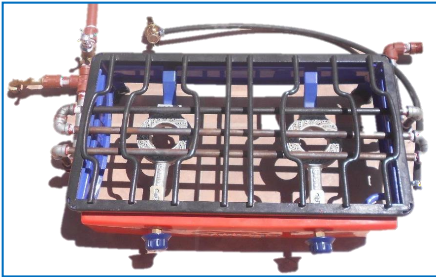
Figura 14: Colector de agua caliente con tuberías de 3/8" y 1/4" de diámetros
