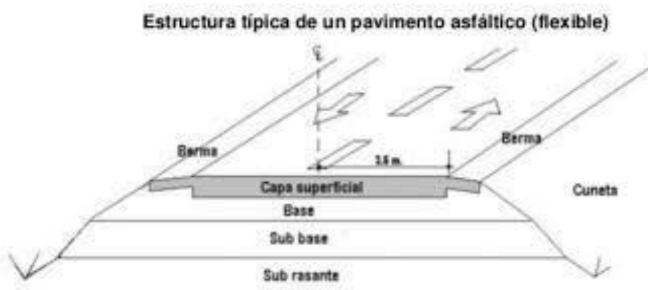
Figura 1: Estructura de un pavimento flexible.
